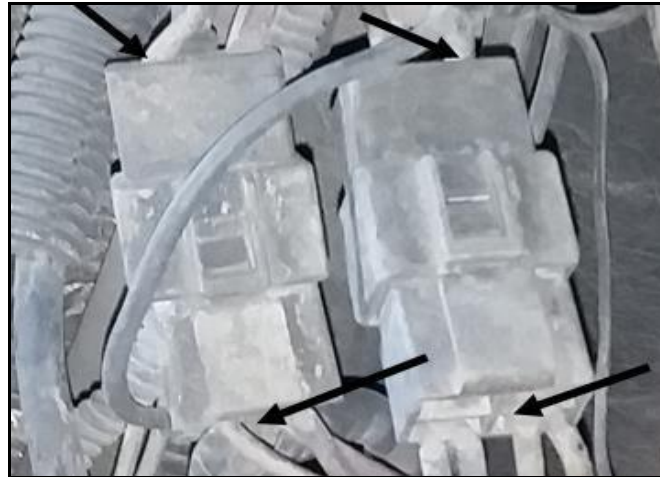
Gambar 13. Penggunaan konektor non hermetically sealed di area mesin
