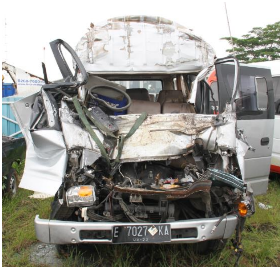
Gambar 2. Deformasi pada body depan diatas rangka mobil Elf
