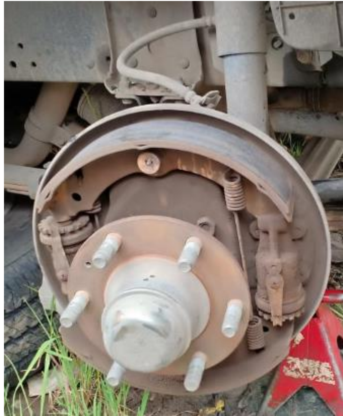
Gambar 9. Komponen rem di tromol mobil Elf lengkap
