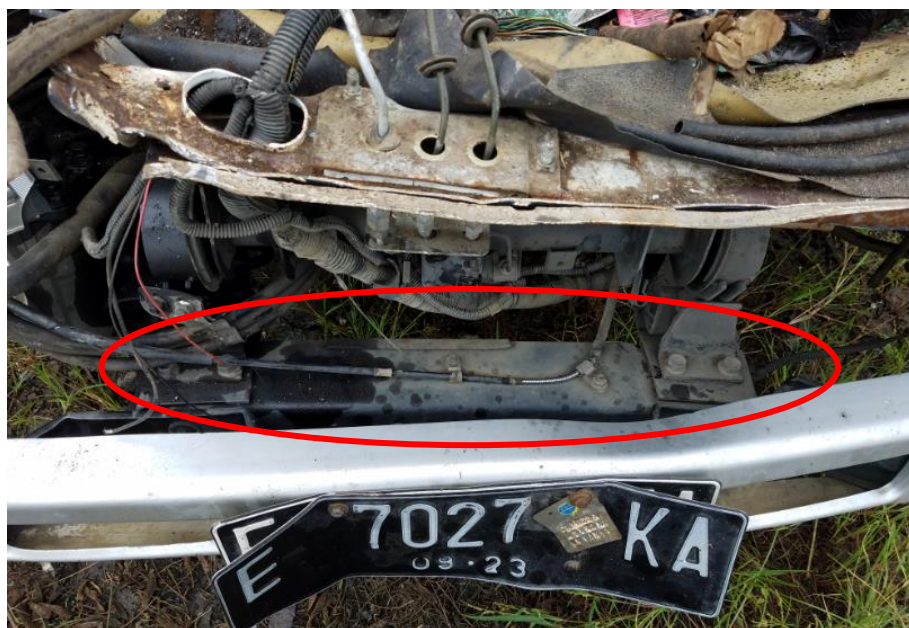
Gambar 6. Kondisi front crossmember mobil Elf tidak terdeformasi
