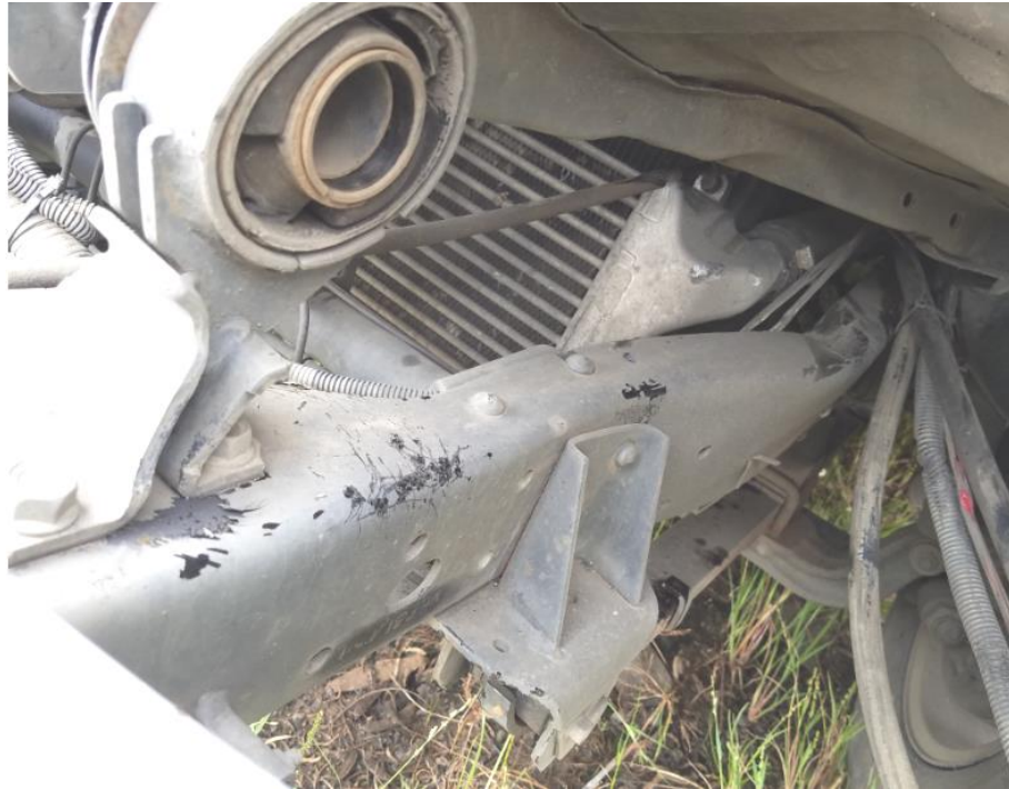
Gambar 7. Kondisi sidemember mobil Elf tidak terdeformasi
