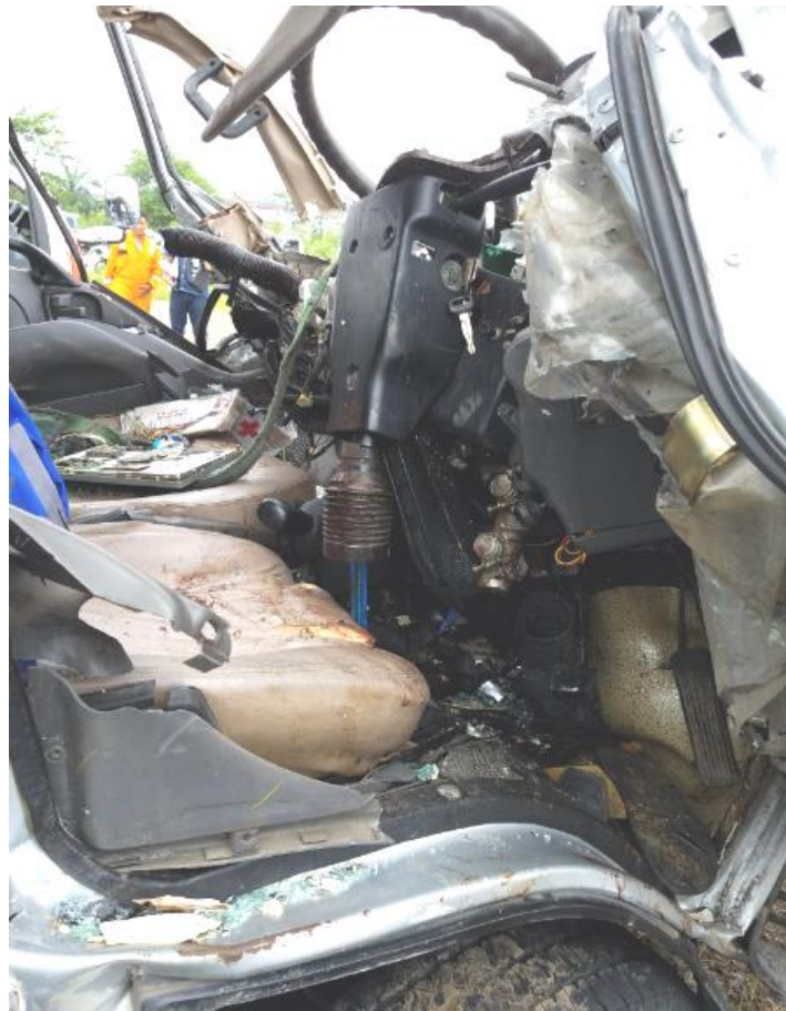
Gambar 8. Batang kemudi patah, kabin terdeformasi
