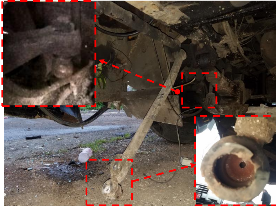
Gambar 12. Relay rod/drag link lepas dari tie rod end ke knuckle arm
