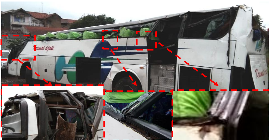
Gambar 7. Superstruktur pilar jendela kiri patah
