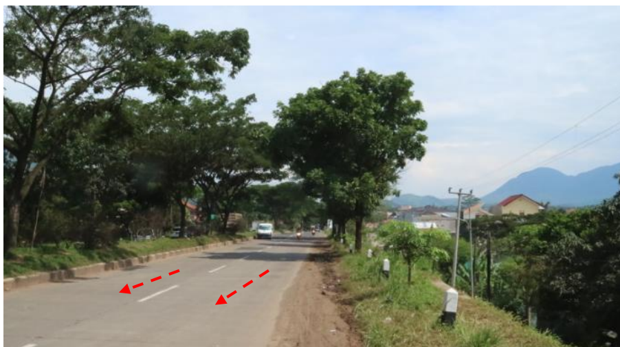
Gambar 14. Jalur arah kecelakaan : lalu lintas 2 lajur searah, kondisi marka tengah pudar, tidak ada marka tepi, terpasang patok jalan.
