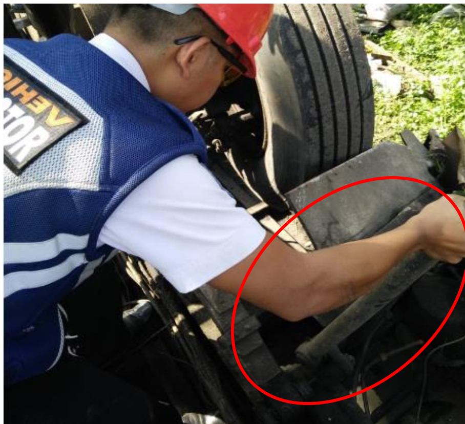
Gambar 13. Petugas memegang relay rod/drag link sesaat mobil bus terguling
