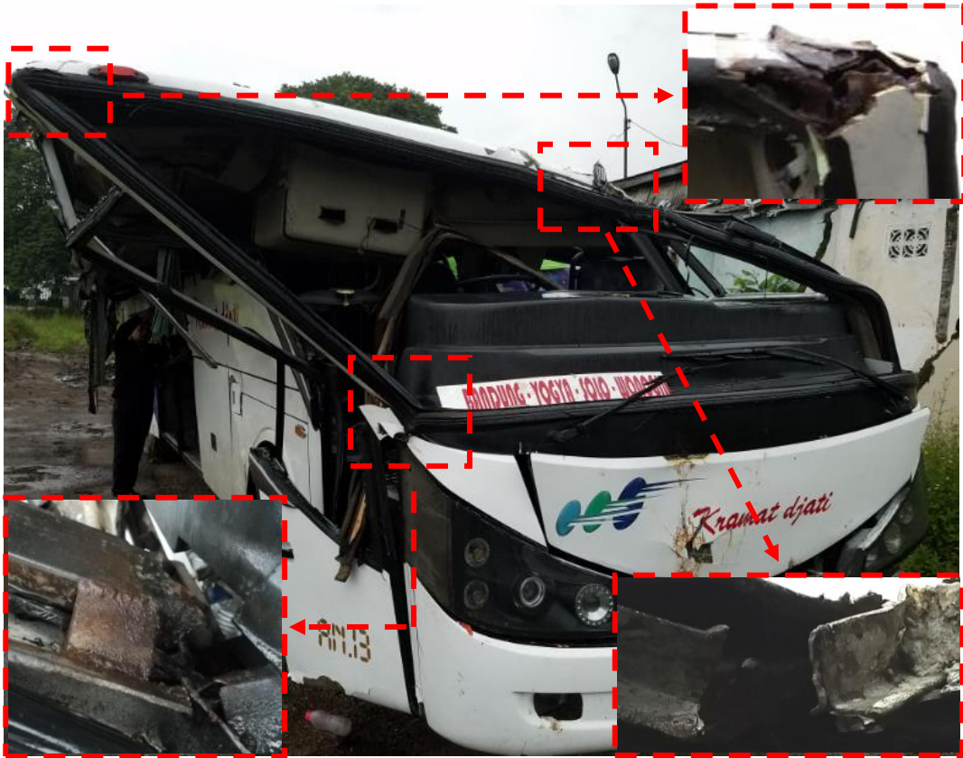
Gambar 6. Superstruktur pilar kaca depan patah
