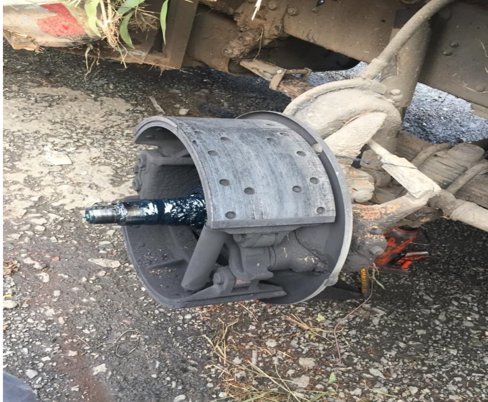
Gambar 11. Kondisi Bagian Kampas Rem Mobil Bus
