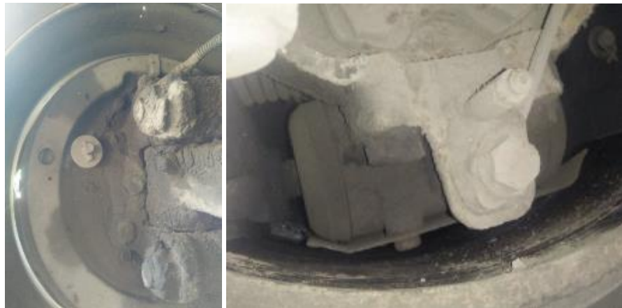
Gambar 18. Pengecekan silinder rem roda kiri depan menunjukkan tidak ada kebocoran minyak hidrolik.
