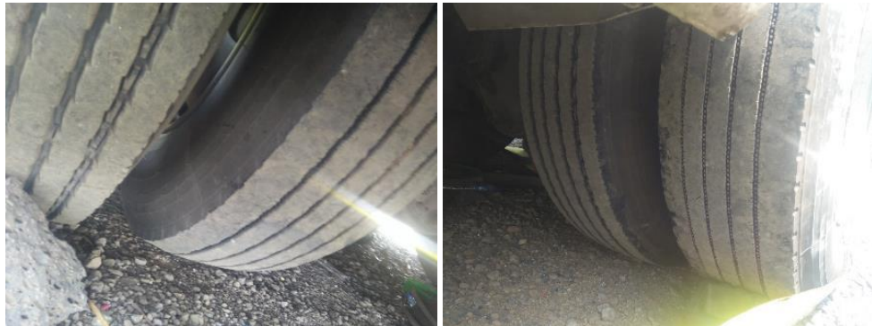
Gambar 21. Pemeriksaan alur ban belakang-kiri (gambar kiri) dan ban belakang-kanan (gambar kanan) menunjukkan alur ban yang masih di atas batas minimum.
