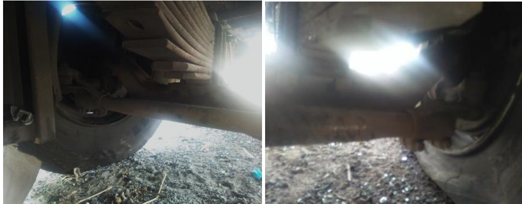
Gambar 14. Kondisi tie rod mobil SJ yang masih bersesuaian dengan standar.
