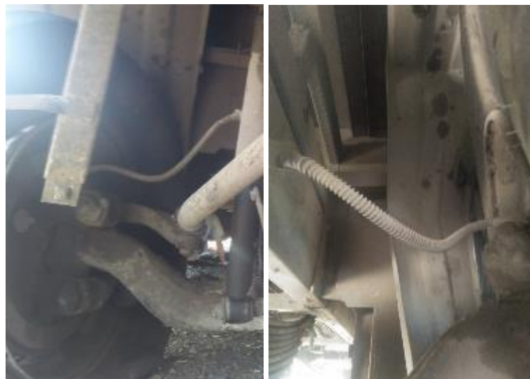
Gambar 16. Pengecekan selang fleksibel ( hose ) menunjukkan bahwa tidak ada kebocoran minyak hidrolis.
