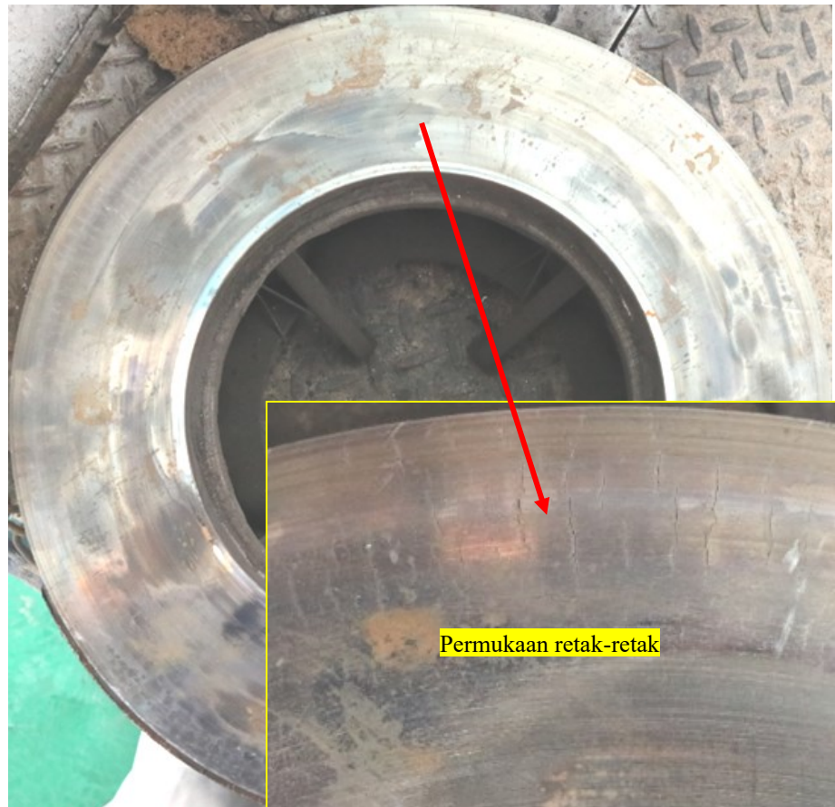
Gambar 12. Permukaan plat penekan kopling banyak retak rambut
