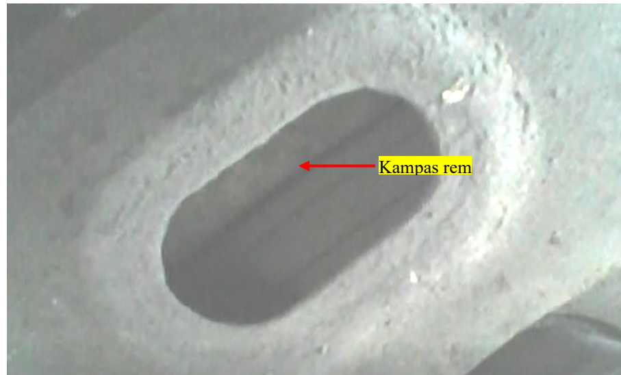
Gambar 5. Ketebalan kampas rem dari celah velg
