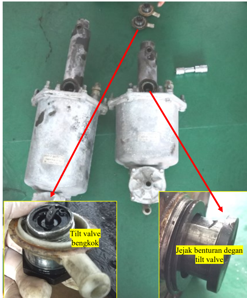
Gambar 13. Komponen rem utama Air Over Hydraulic
