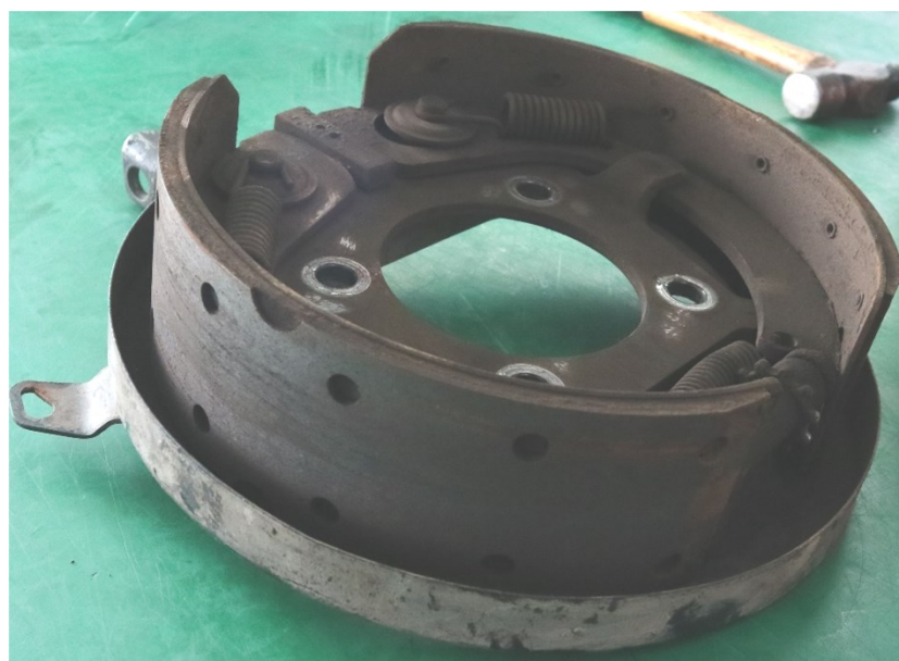
Gambar 14. Ketebalan kampas rem tangan
