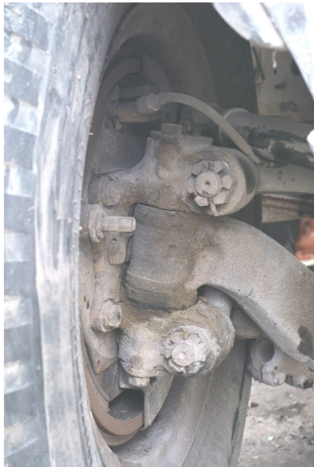
Gambar 4. Roda depan kanan tidak ada kebocoran minyak rem
