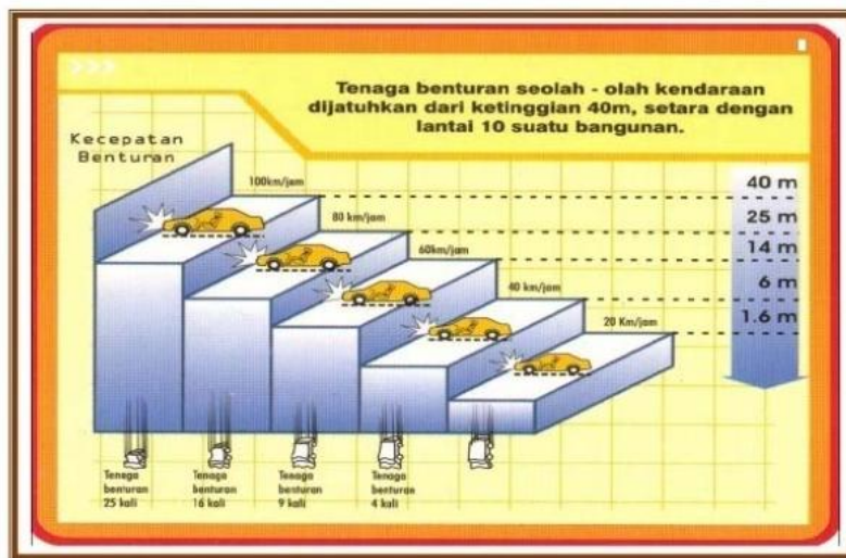
Gambar 9. Perbandingan Tenaga Benturan dengan Kecepatan Benturan
