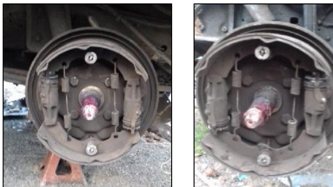
Gambar 3. Kondisi Tromol setelah dibongkar
