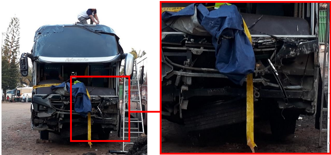
Gambar 12. Deformasi pada bagian depan mobil bus.
