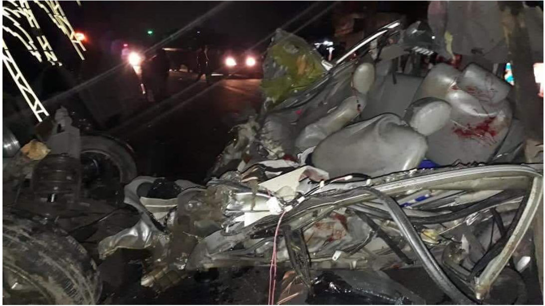
Gambar 57. Deformasi parah pada bagian kabin penumpang.
