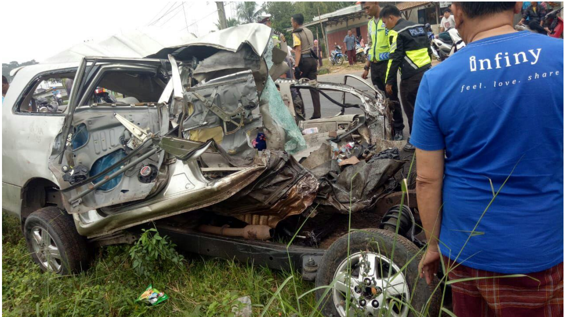
Gambar 58. Deformasi parah pada bagian kabin penumpang (lanjutan).
