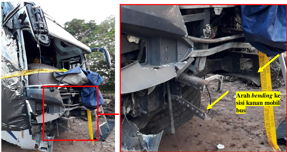
Gambar 13. Bending pada rangka bumper depan mobil bus.
