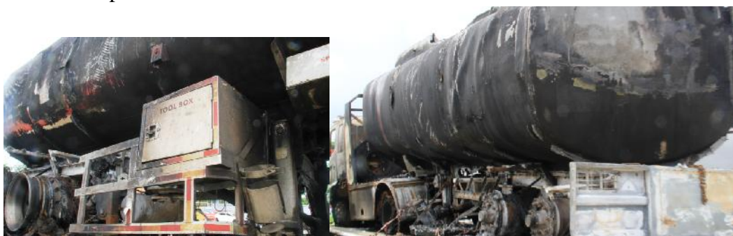
Gambar 5. Kerusakan pada Kereta Tempelan
