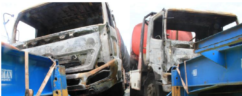
Gambar 3. Kerusakan pada Heat Tractor
