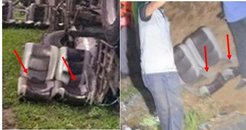
Gambar 10. Kondisi Tempat Duduk Penumpang Tidak Ada Sabuk Keselamatan
