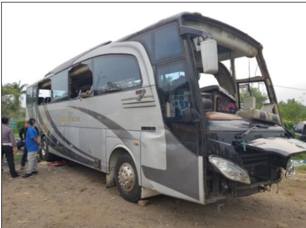
Gambar 3. Samping Kanan Mobil Bus Kondisi Kaca Jendela Pecah Saat Evakuasi
