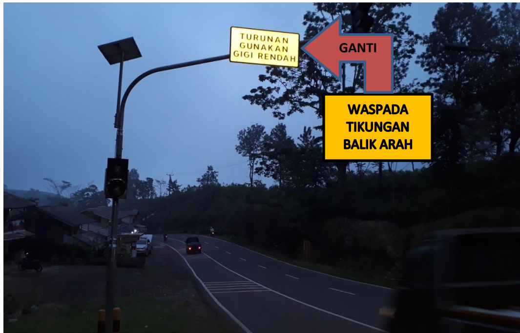
Gambar 36. Rambu Peringatan Tikungan Gabungan Balik Arah
