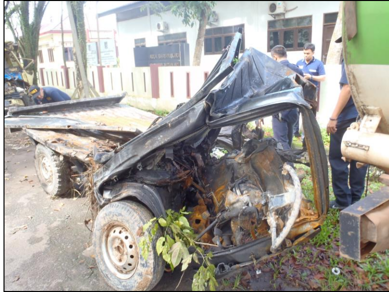
Gambar 4. Kondisi Bagian Depan Pickup
