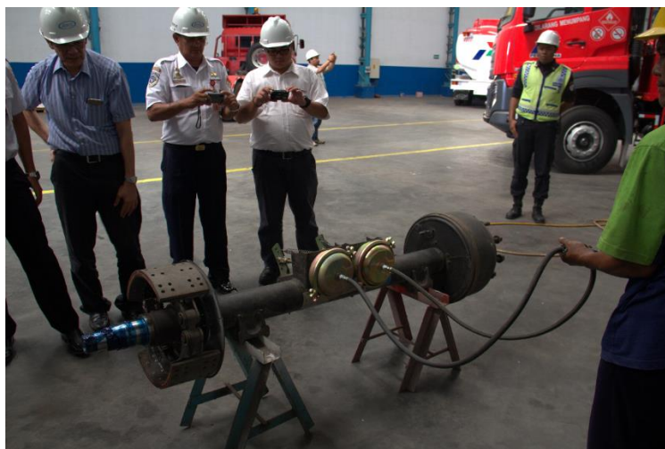
Gambar 47. Demo cara kerja sistem pengereman full air brake pada kereta tempelan.
