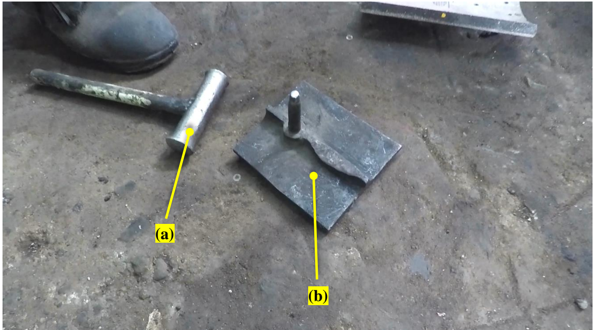
Gambar 13. Peralatan yang digunakan untuk mengeling kampas rem pada sepatu rem. (a) adalah palu, (b) adalah dudukan khusus untuk penempatan paku keling.
