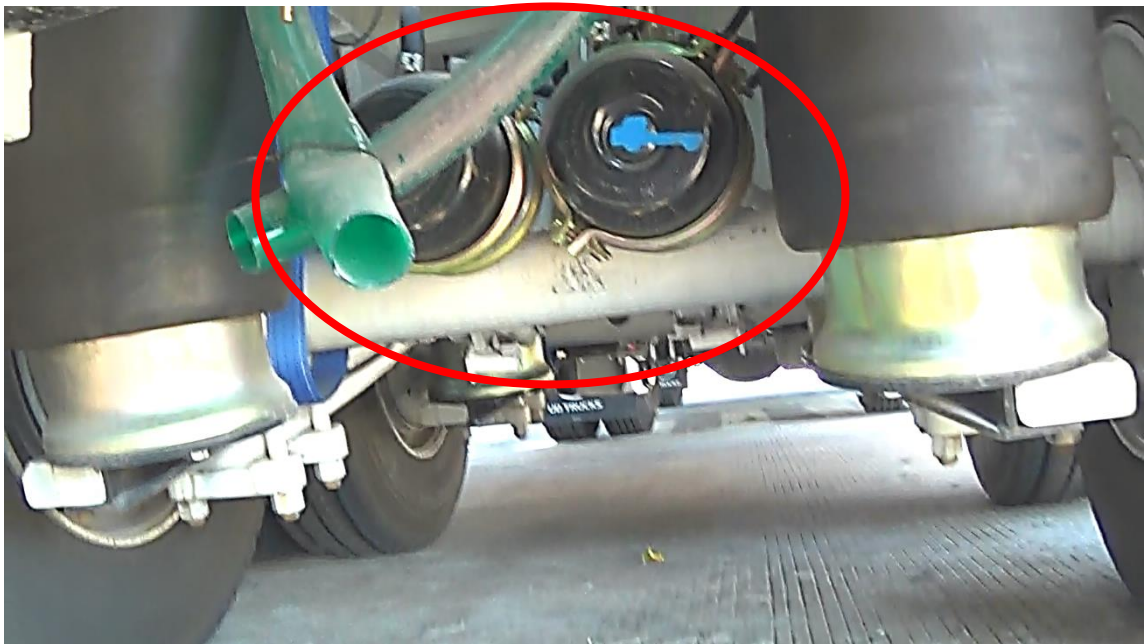
Gambar 28. Lokasi brake chamber yang memiliki komponen parking brake chamber pada kereta tempelan AWECO 24 kL.
