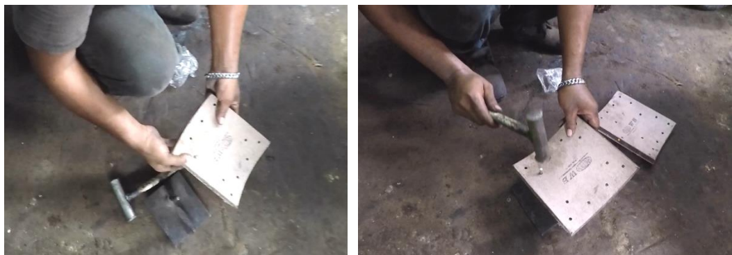
Gambar 14. Pengelingan kampas rem pada sepatu rem.
