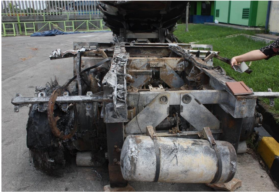
Gambar 8. Kondisi landasan kereta tempelan tangki bagian belakang-kanan.
