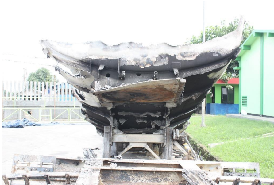
Gambar 10. Kondisi tangki bagian belakang-kanan.
