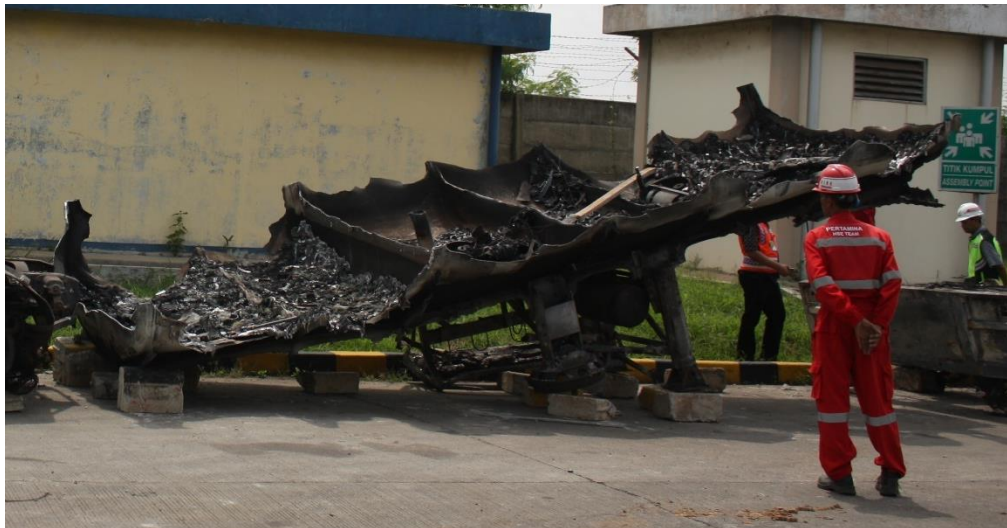
Gambar 9. Kondisi tangki bagian belakang-kanan.
