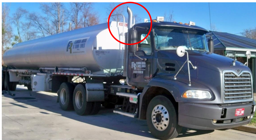
Gambar 34. Posisi knalpot tractor head truk semi trailer tangki yang berada di belakang kabin pengemudi di Amerika Serikat.
