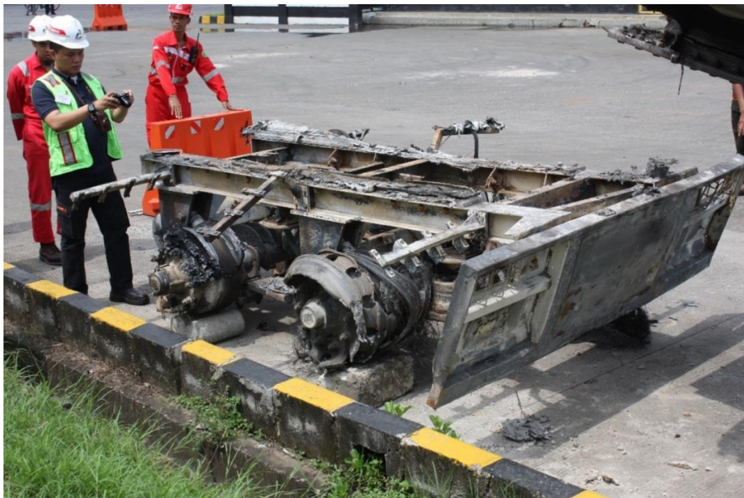
Gambar 7. Kondisi landasan kereta tempelan tangki bagian belakang-kanan.
