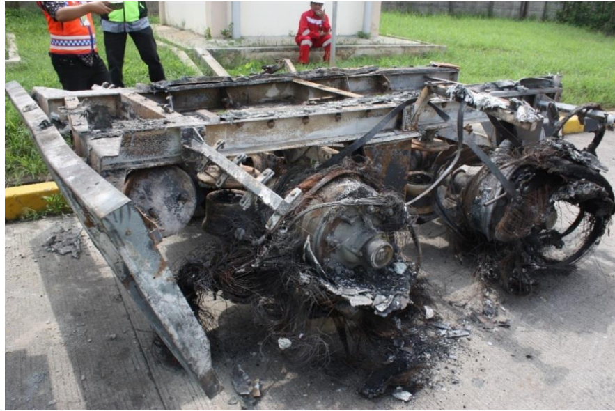
Gambar 6. Kondisi landasan kereta tempelan tangki bagian kanan-belakang. c. Keseluruhan ban terbakar (Gambar 7, Gambar 8);
