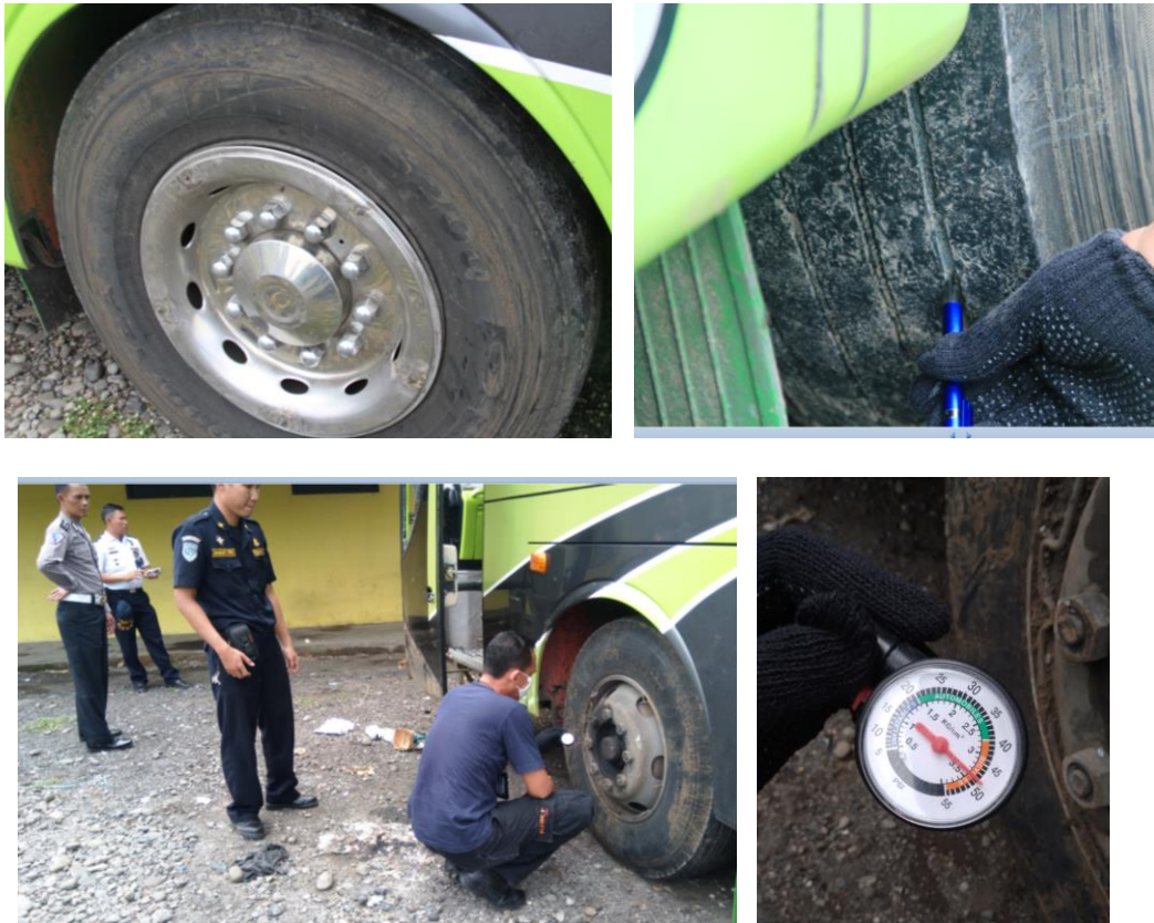
Gambar 5. Kondisi ban banyak sayatan mencapai benang lapisan
