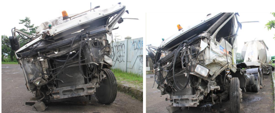
Gambar 3. Kerusakan Truk Semen Curah
