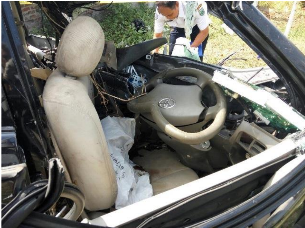
Gambar 10. Kondisi Kemudi Mobil Penumpang yang Tidak Terdapat Bekas Air Bag yang Terbuka
