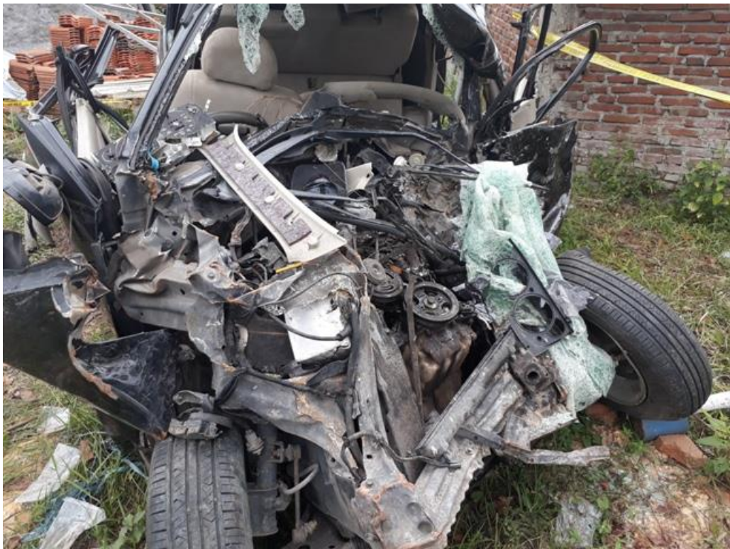
Gambar 9. Kondisi Crumple Zone yang Rusak Akibat Tabrakan
