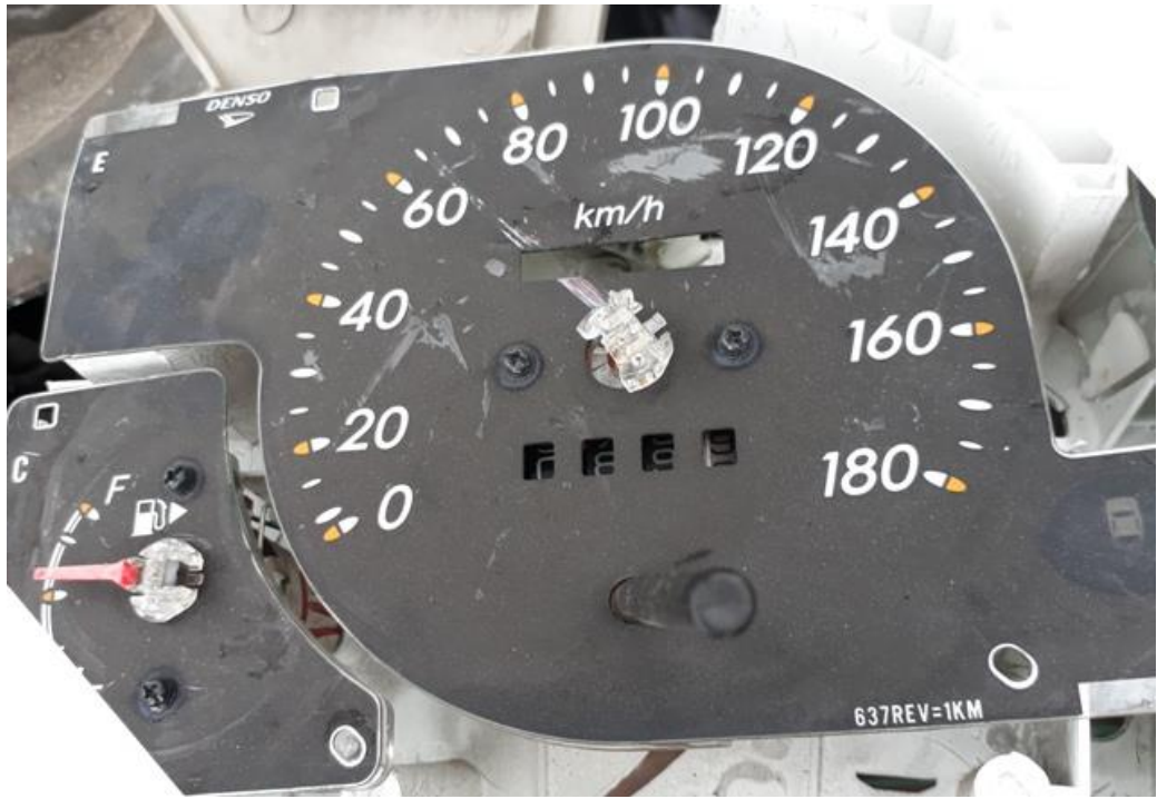
Gambar 8. Bekas Jarum Speedometer pada saat Terjadi Kecelakaan
