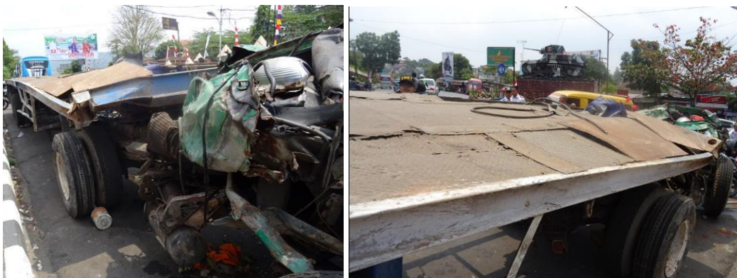
Gambar 17. Kondisi kereta tempelan sisi kanan pasca kejadian kecelakaan.
