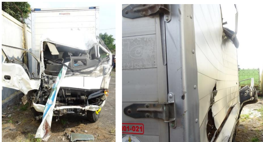
Gambar 39. Kondisi truk box setelah terjadinya kecelakaan.
