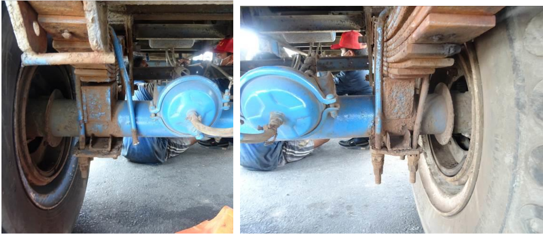
Gambar 37. Kondisi roda kereta tempelan sumbu 3 yang tidak ada tutup tromolnya. Gambar kiri roda kiri sumbu 3. Gambar kanan roda kanan sumbu 3.
