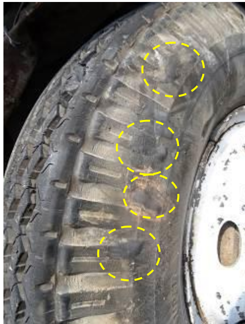
Gambar 27. Tambalan pada dinding ban roda kiri sumbu 1.
