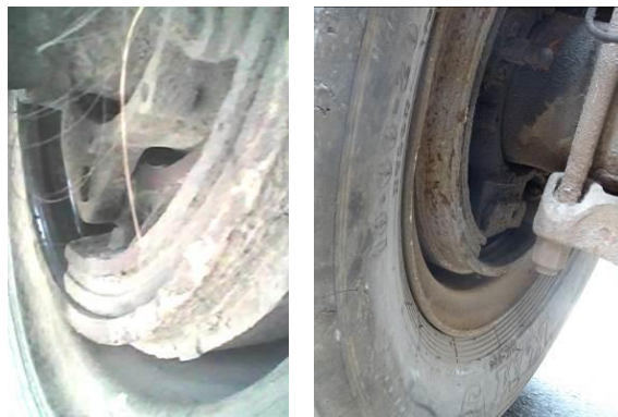
Gambar 29. Kondisi roda sumbu 2 yang tromolnya tidak ada tutup tromol. Gambar kiri roda kiri sumbu 2 gambar kanan roda kanan sumbu 2.
