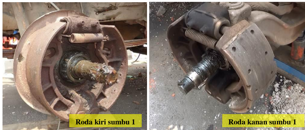
Gambar 28. Kondisi kelengkapan tutup tromol pada roda sumbu 1. Pada gambar kanan terlihat roda sumbu kanan yang tidak ada tutupnya.
