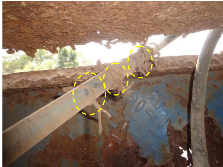
Gambar 34. Pengikat pada selang fleksibel kereta tempelan.
