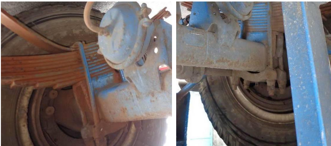
Gambar 36. Kondisi roda kereta tempelan sumbu 3 yang tidak ada tutup tromolnya. Gambar kiri roda kiri sumbu 3. Gambar kanan roda kanan sumbu 3.
