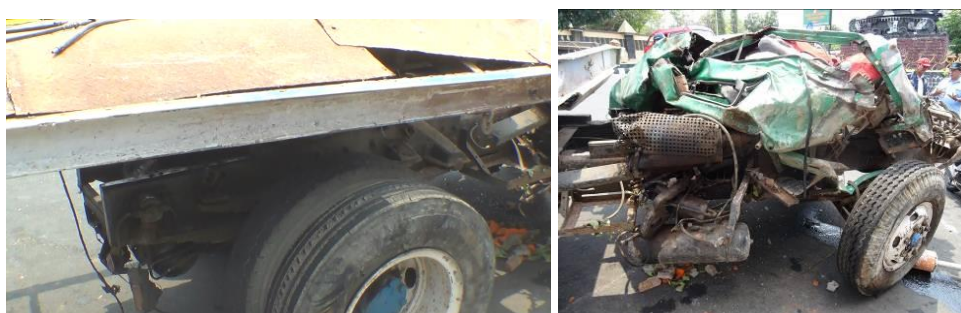
Gambar 12. Kondisi head tractor sisi kanan pasca kejadian.
