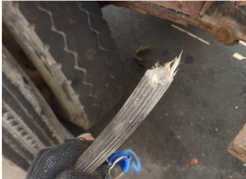
Gambar 13. Selang udara rem pada head tractor yang terputus.
