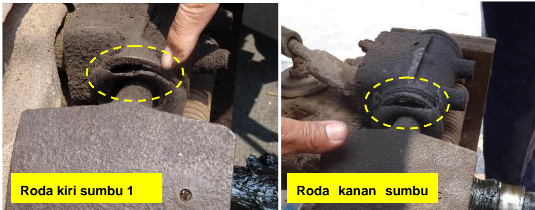
Gambar 24. Karet tutup master rem yang terkikis.
