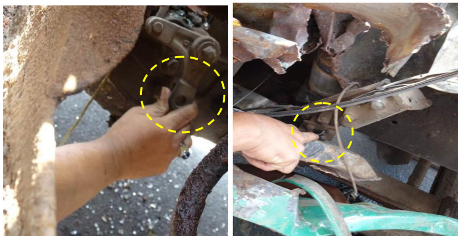
Gambar 25. Komponen rem tangan head tractor dan exhaust brake tidak ada.
