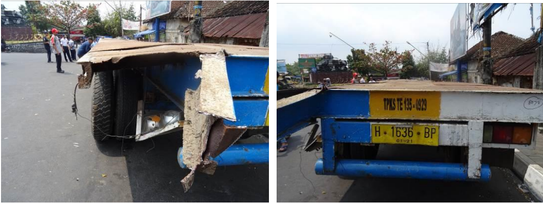
Gambar 15. Kondisi kereta tempelan sisi belakang pasca kejadian.
