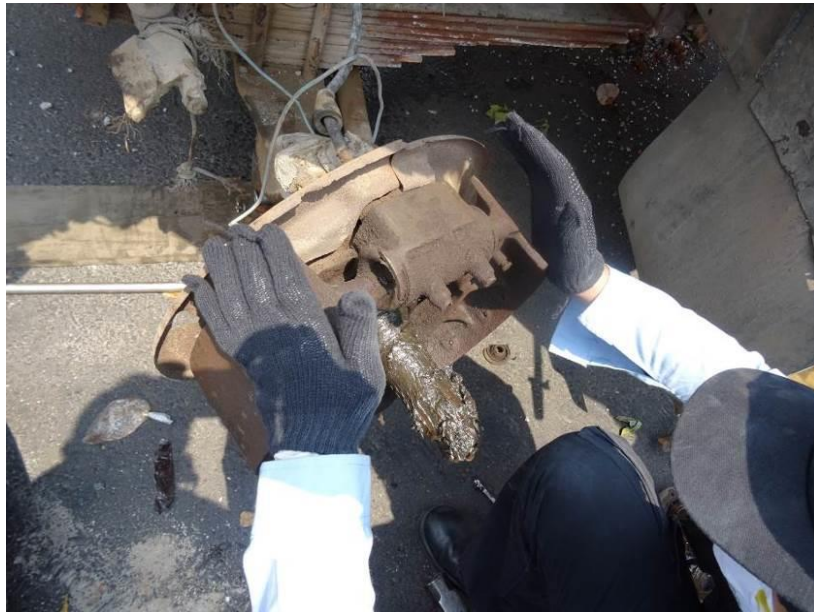
Gambar 26. Pengecekan mekanisme sepatu rem.
