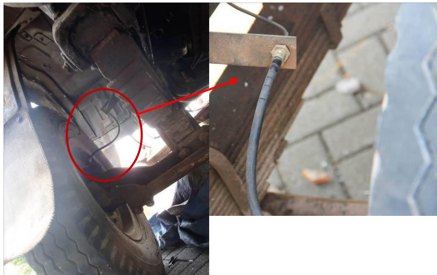
Gambar 10. Rubber flexible hose di sumbu depan kiri mengalami penuaan dan bocor
