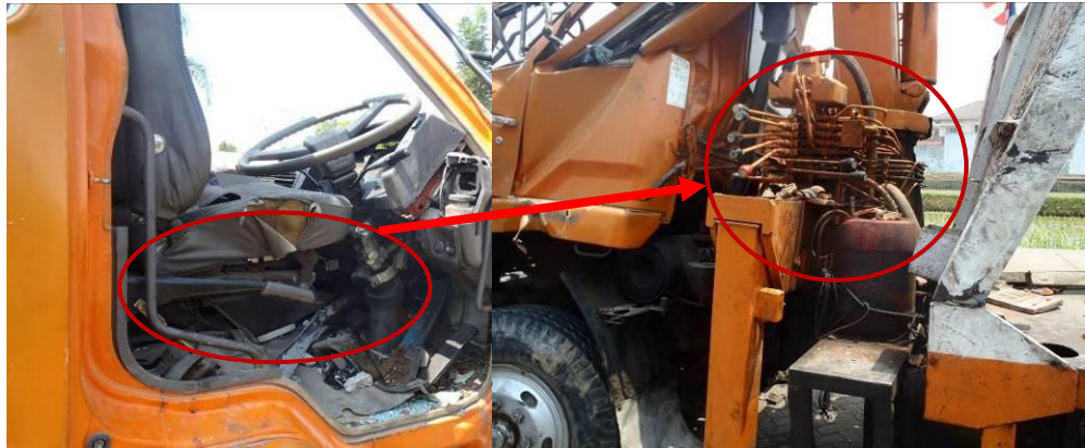
Gambar 11. Parking brake berubah fungsi menjadi tuas pengaktif hydrolic crane
