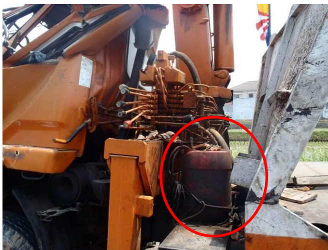
Gambar 13. Tangki bahan bakar bocor diganti memakai jerigen
