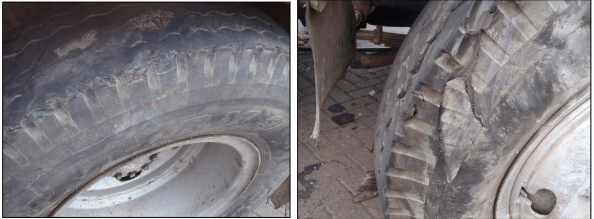
Gambar 14. Kondisi ban banyak sayatan mencapai benang lapisan
