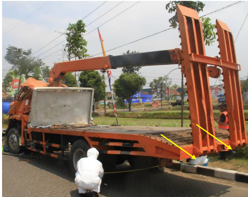
Gambar 18. Pemasangan rantai tambahan memakai engsel
