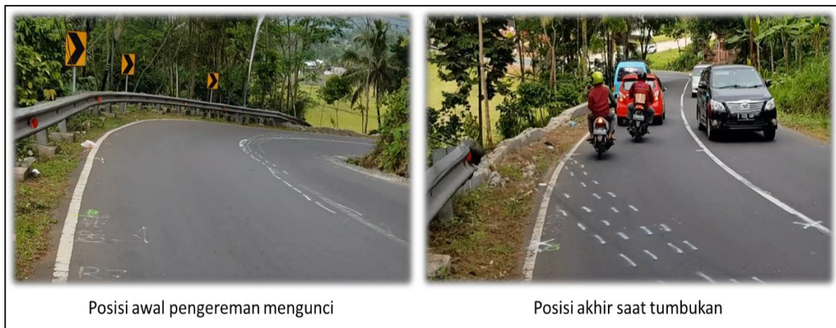
Gambar 22. Skid Mark di LKK pada Titik Awal dan Titik Akhir
