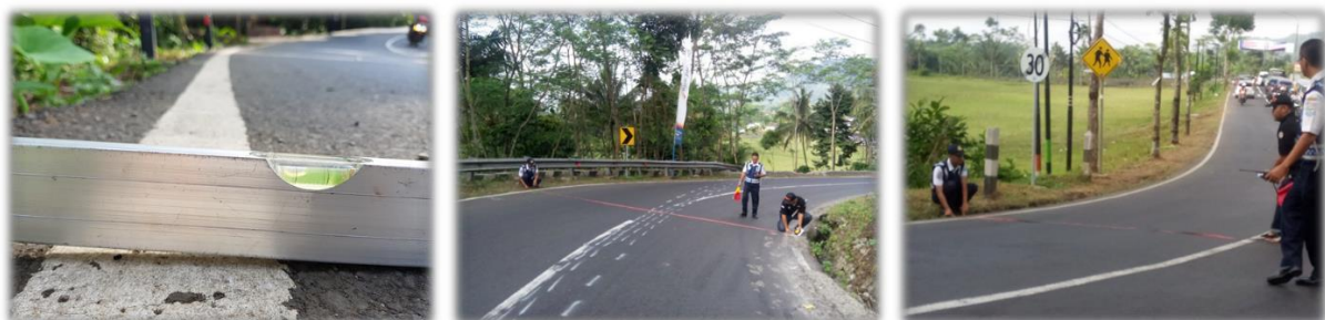
Gambar 10. Penentuan Superelevasi dan Penghitungan Manual
