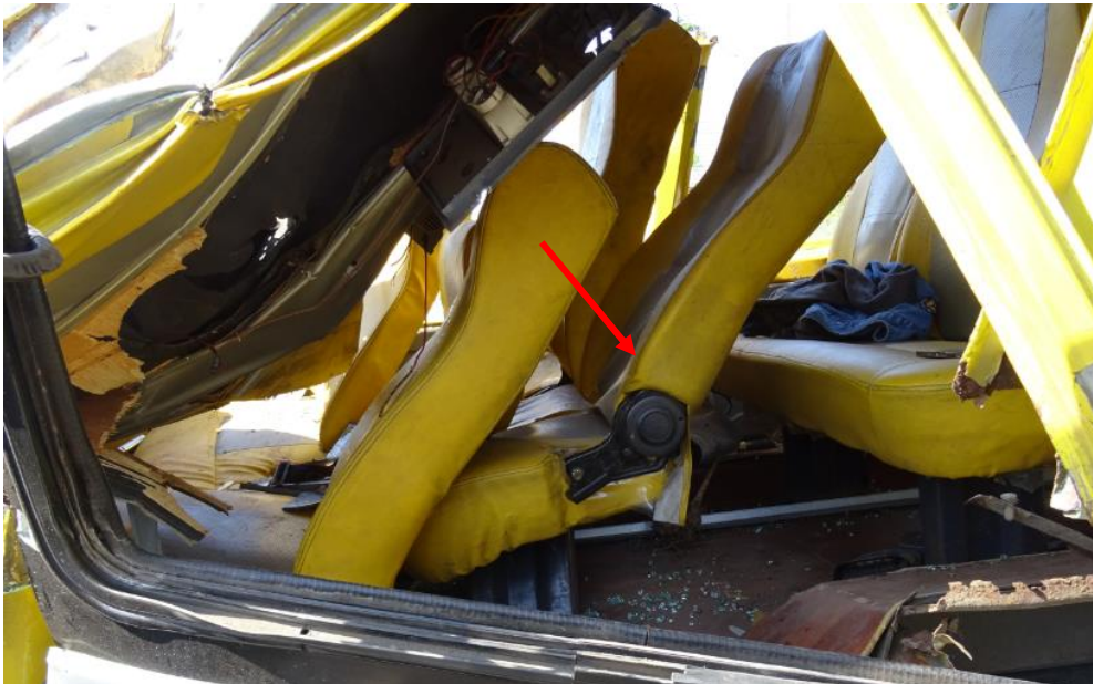
Gambar 8. Sabuk keselamatan tidak terpasang di kursi penumpang.
