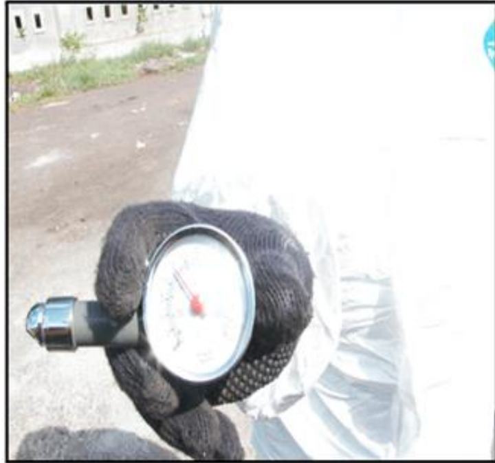
Gambar 3. Tekanan udara di keempat ban 39-41 psi.
