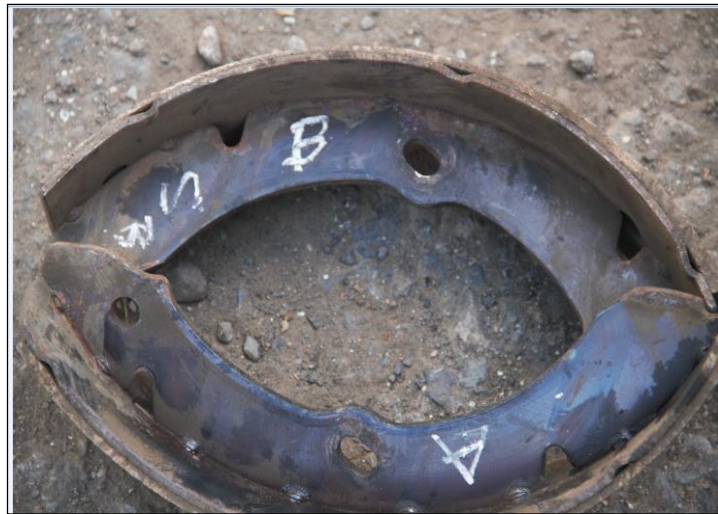
Gambar 4. Ketebalan kampas rem sumbu depan kiri tidak rata (1- 5 mm)
