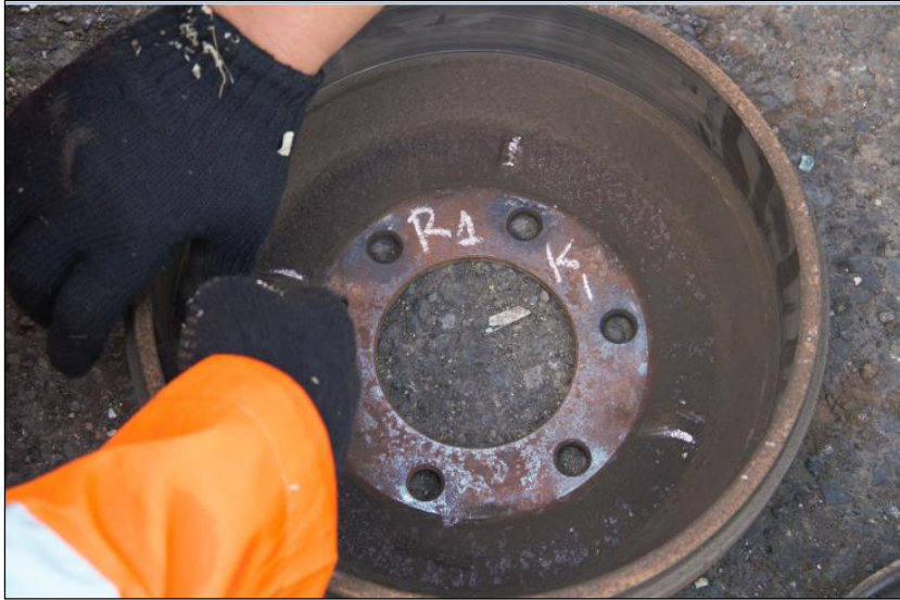
Gambar 5. Permukaan dalam Tromol sumbu depan kiri sudah aus.
