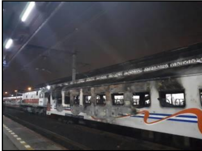
Gambar 4. Kondisi bagian bodi kereta K3 0 66 40 yang terbakar
