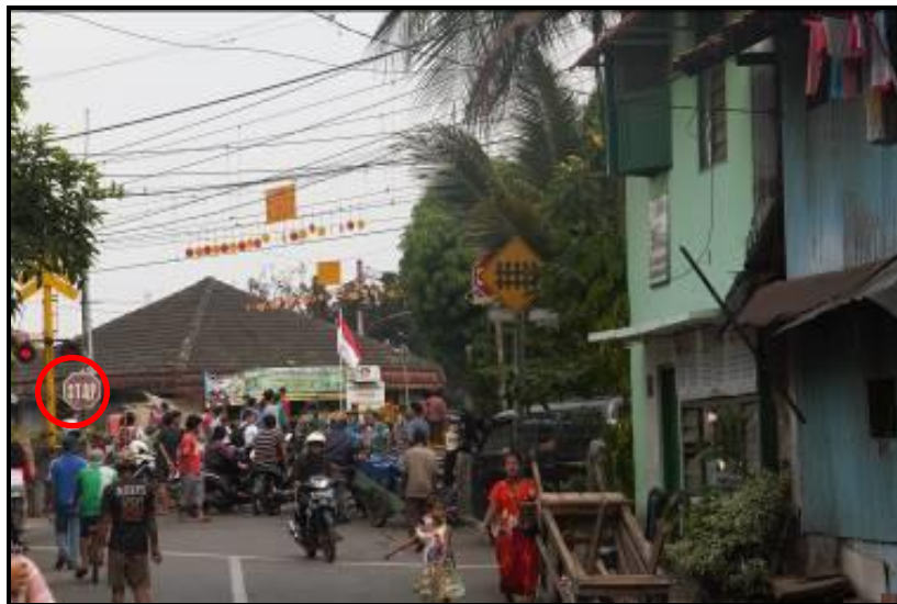
Gambar 11. Rambu dilarang berjalan terus yang terletak pada jarak 3 meter dari perlintasan sebidang
