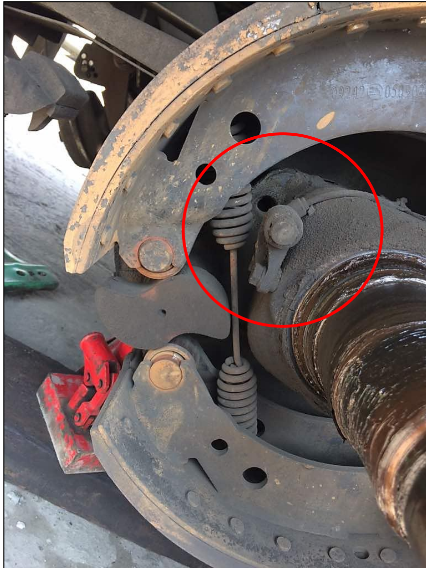
Gambar 14.. Perangkat Keselamatan Teknologi E-ABS Tangki Trailer
