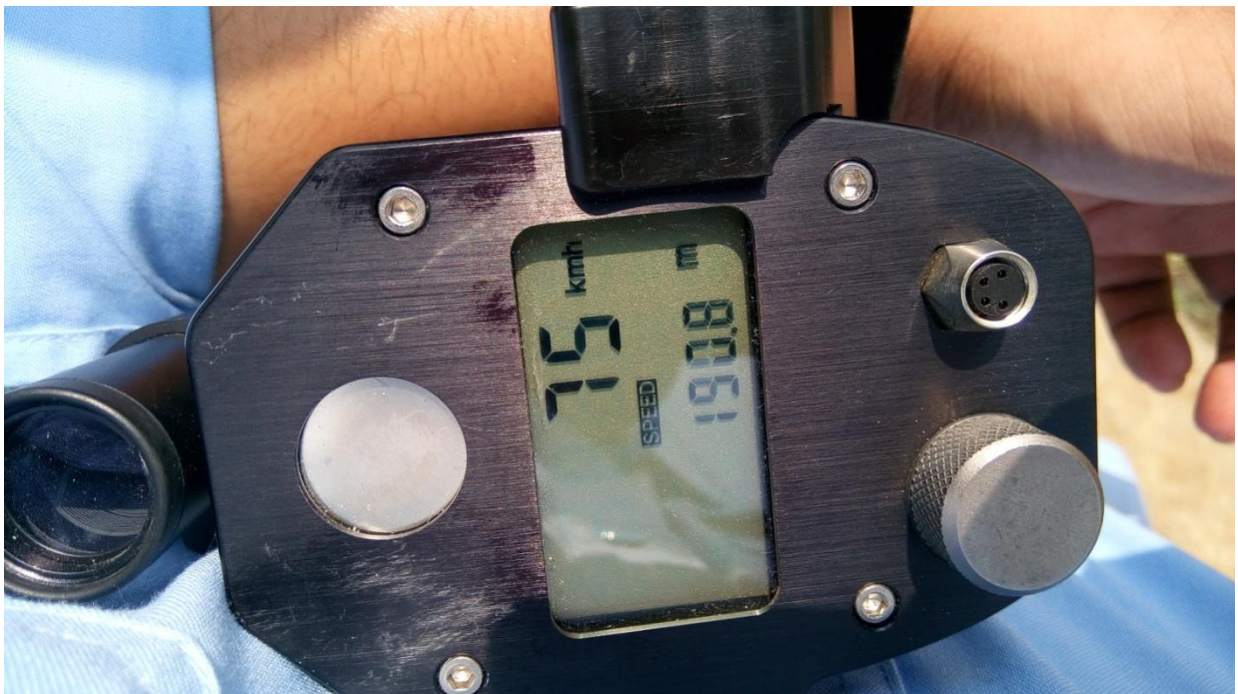
Gambar 11. Test kecepatan kereta yang melintas dan tidak berhenti pada stasiun KA Kroya ( 75 km/jam )
