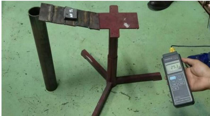
**Gambar 40. Pengukuran temperatur sampel yang dilakukan uji bakar.**
