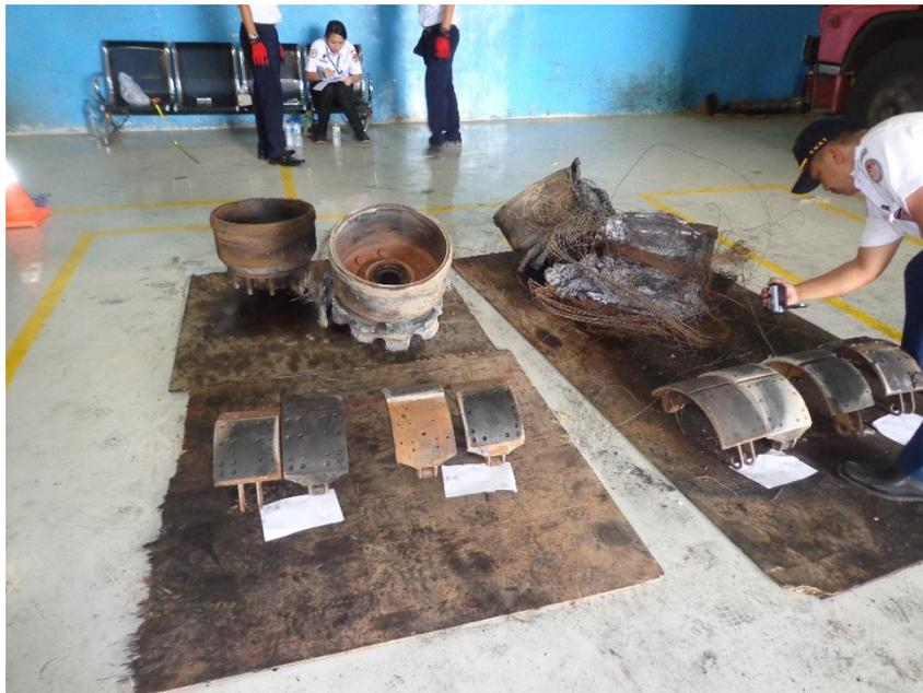
**Gambar 17. KNKT melakukan rekonstruksi komponen sistem pengereman kereta tempelan di depo Plumpang PT**
