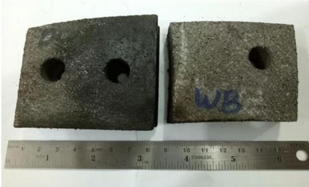
Gambar 38. Pengukuran *brake pad* sebelum dipotong untuk sampel.
