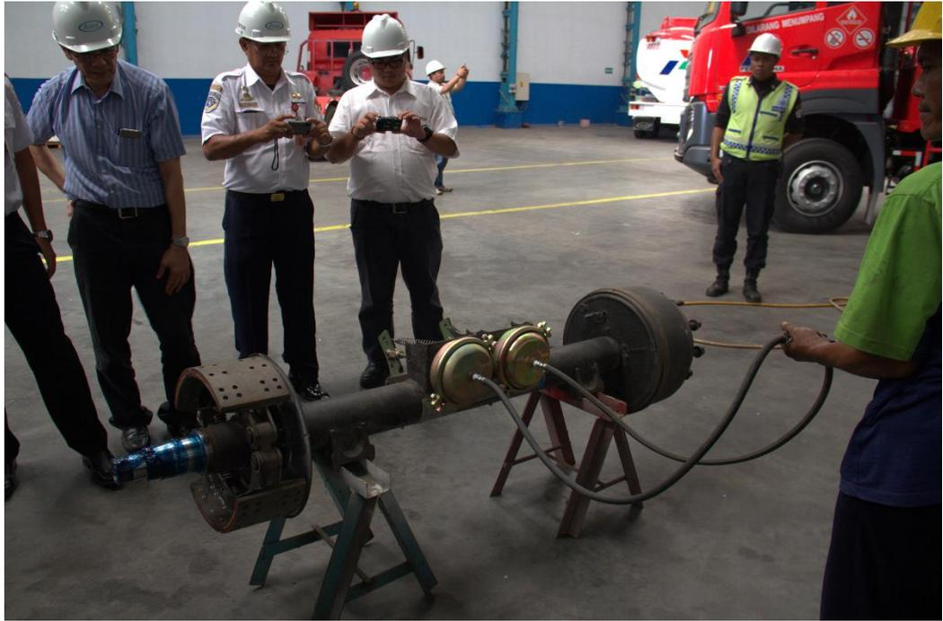
Gambar 58. Demo cara kerja sistem pengereman *full air brake* pada kereta tempelan.
