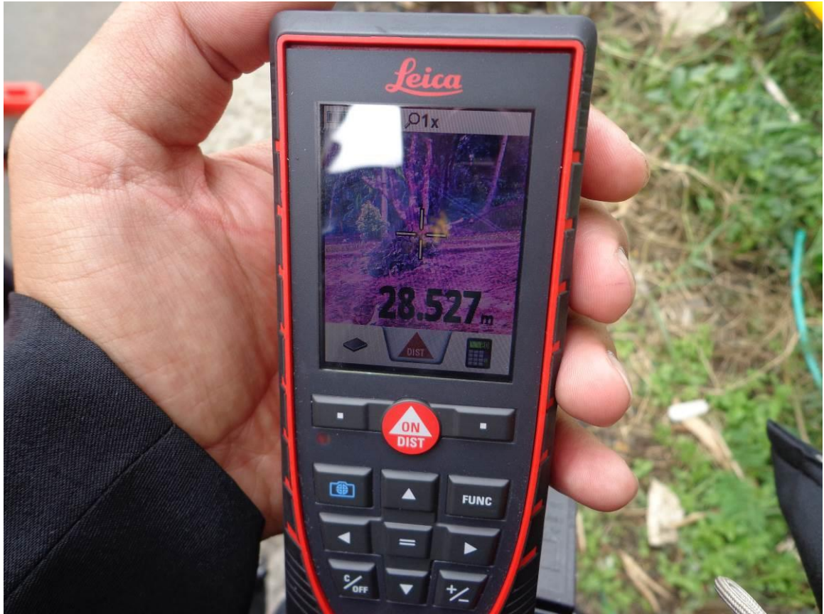
Gambar 10. Hasil pengukuran jarak antara titik mobil bus keluar jalur dengan posisi akhir mobil bus dengan menggunakan laser distance meter gauge .
