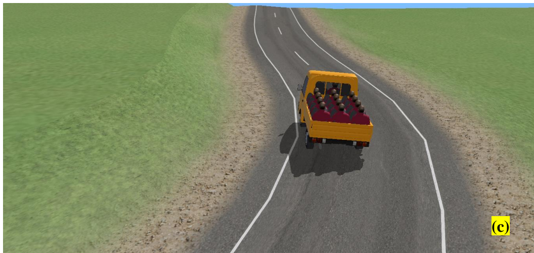
Gambar 44. Pergerakan mobil pickup yang dapat melalui tikungan kedua walaupun sempat mengambil lajur berlawanan arah.
