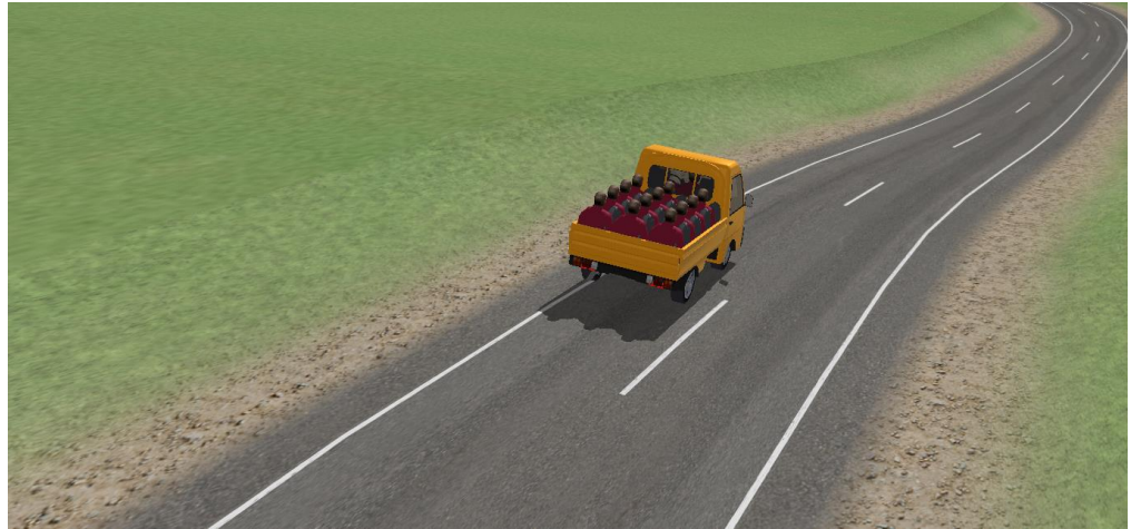
Gambar 36. Mobil pickup dengan kondisi penumpang duduk dan kecepatan 70 km/jam melewati tikungan pertama dengan dikemudikan secara aggressive .
