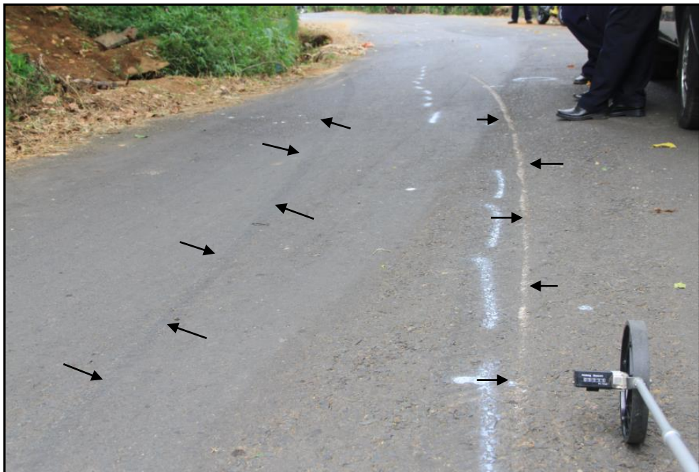
Gambar 13. Skidmark dan Scratch Mark di lokasi.
