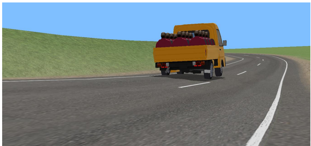
Gambar 43. Mobil pickup yang mengalami rolling ke kiri dengan besaran sudut 5,15^\circ setelah melewati tikungan pertama.
