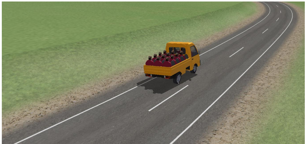
Gambar 37. Roda mobil pickup yang terangkat ketika mobil pickup yang dalam kondisi dikemudikan secara aggressive dan penumpang belakang dalam keadaan duduk telah melewati tikungan pertama.
