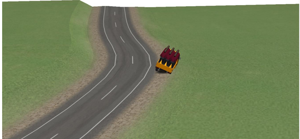
Gambar 27. Mobil pickup keluar jalur menjelang tikungan pertama pada simulasi dengan pengemudi mode aggressive dan kecepatan 70 km/jam (lanjutan).
