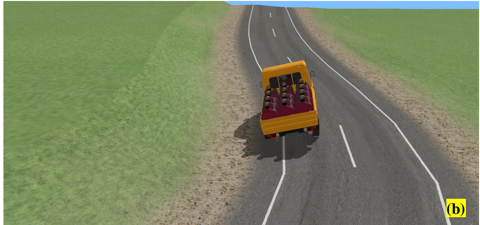
Gambar 42. Pergerakan mobil pickup ketika dilakukan pengereman mendadak menjelang tikungan pertama dimana penumpang belakang dalam kondisi duduk dan mobil pickup dikemudikan secara aggressive pada kecepatan 70 km/jam.
