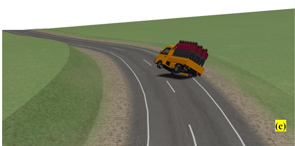
Gambar 28. Gerakan mobil pickup ketika dilakukan pengereman mendadak menjelang tikungan kedua dimana pengemudian dilakukan secara aggressive dan kecepatan 70 km/jam.
