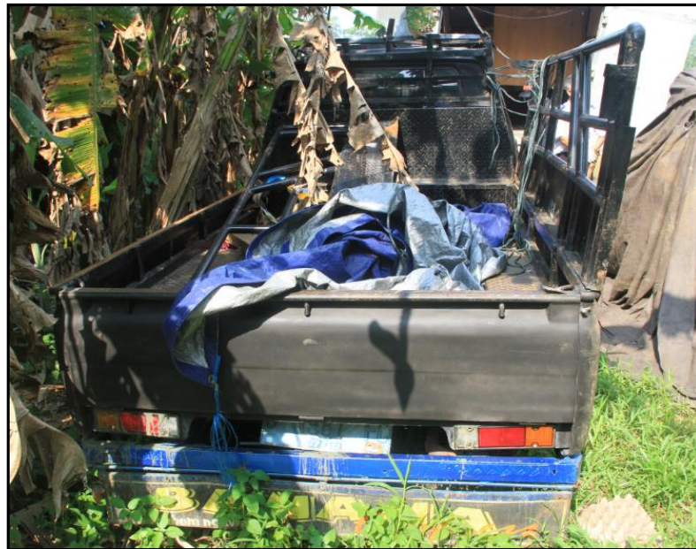
Gambar 5. Kondisi bagian belakang pickup setelah terjadinya kecelakaan.
