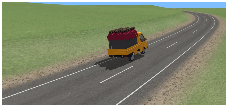
Gambar 29. Ban kanan-depan yang terangkat pasca melewati tikungan pertama.
