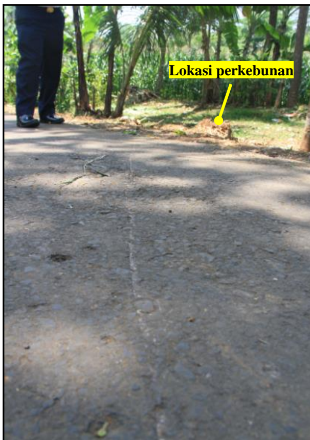
Gambar 16. Arah Scratch Mark setelah pickup menabrak dinding.
