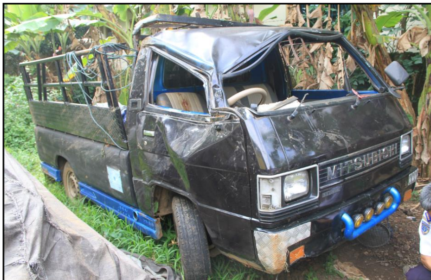
Gambar 3. Kondisi bagian sebelah kanan pickup setelah terjadinya kecelakaan.
