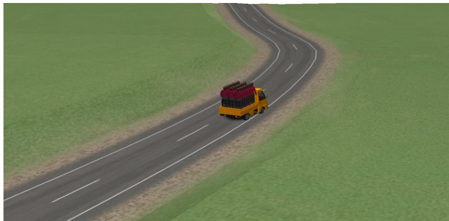
Gambar 26. Mobil pickup keluar jalur menjelang tikungan pertama pada simulasi dengan pengemudi mode aggressive dan kecepatan 70 km/jam.
