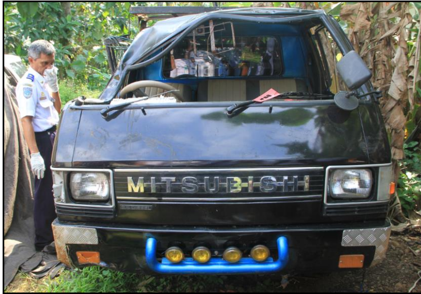
Gambar 2. Kondisi bagian depan pickup setelah terjadinya kecelakaan.
