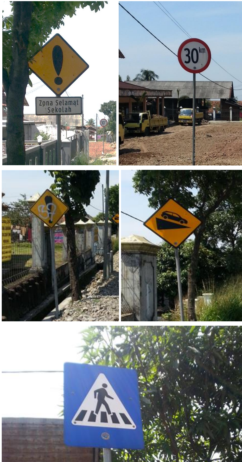
Gambar 27. Rambu Peringatan ZOSS, Rambu Batas Kecepatan Max 30 km/jam, Rambu Peringatan Hati-Hati, Rambu Peringatan Turunan dan Rambu Petunjuk Tempat Penyeberangan Orang.
