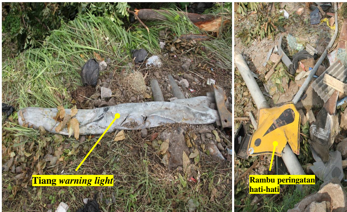
Gambar 30. Kondisi perlengkapan di sekitar lokasi terjadinya kecelakaan.
