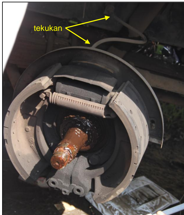
Gambar 20. Gambar konstruksi selang fleksibel rem UD Truck CB 87 PS.
