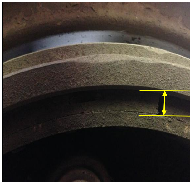
Gambar 6. Ketebalan kanvas rem roda kanan – belakang masih cukup tebal.
