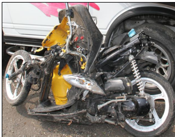
Gambar 13. Kondisi Kerusakan Sepeda Motor Yamaha Mio D-4285-KC
