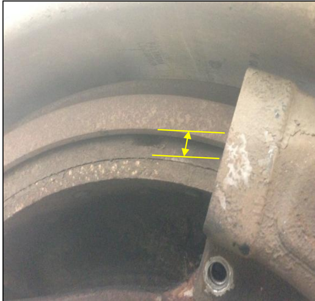
Gambar 3. Ketebalan kanvas rem roda kiri – depan masih cukup tebal.
