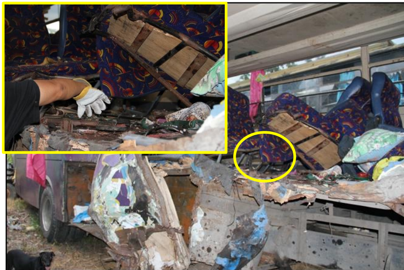
Gambar 6. Korosi pada superstructure
