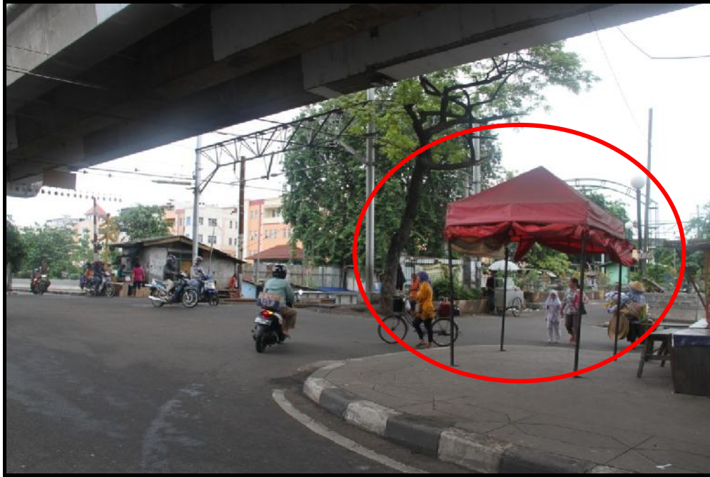
Gambar 23. Ruang bebas pandang pengemudi metromini terhalang oleh keberadaan bangunan dan pohon sehingga pengemudi tidak dapat melihat KA KRL 1528 yang melaju dari arah Stasiun Kampung Bandan.
