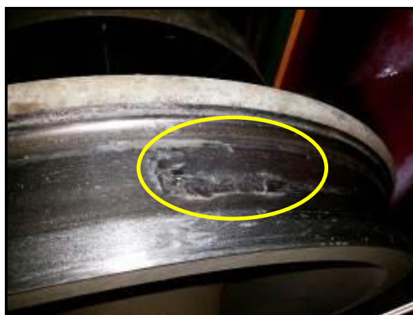
Gambar 16. Tapak roda aus.
