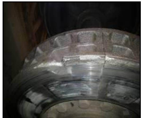
Gambar 9. Disc brake terkikis dan permukaan disc tergores
