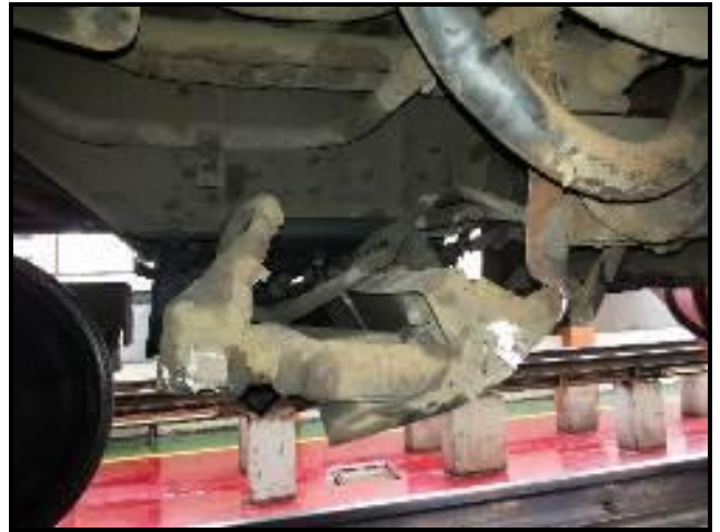
Gambar 7. Unit ATS terlepas dan horn rusak
