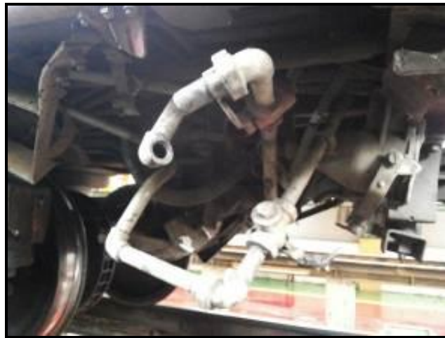
Gambar 13. Pipa sistem udara saluran pengereman patah
