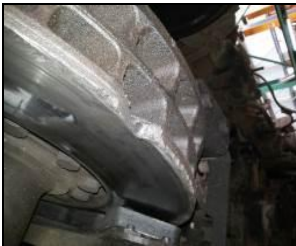
Gambar 9. Disc brake terkikis dan permukaan disc tergores
