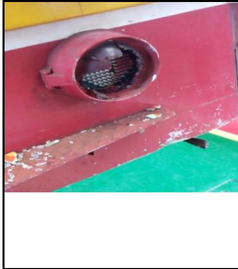
Gambar 12. Tutup lampu dan lampu semboyan 21 pecah
