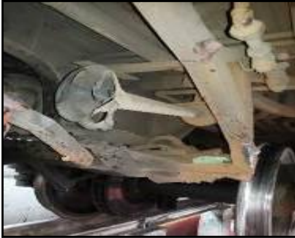
Gambar 7. Unit ATS terlepas dan horn rusak
