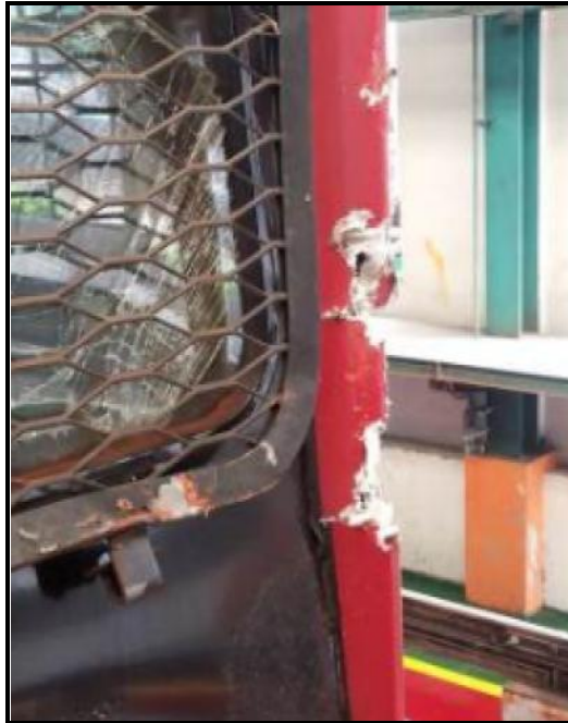
Gambar 10. Body bagian depan sebelah kiri rusak
