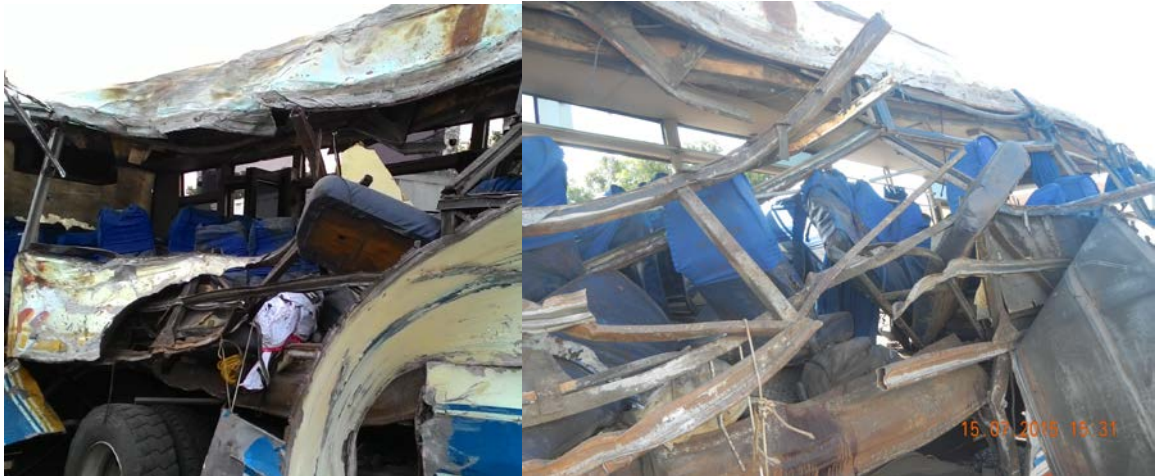
Gambar 22. Temuan korosi pada superstructure mobil bus.
