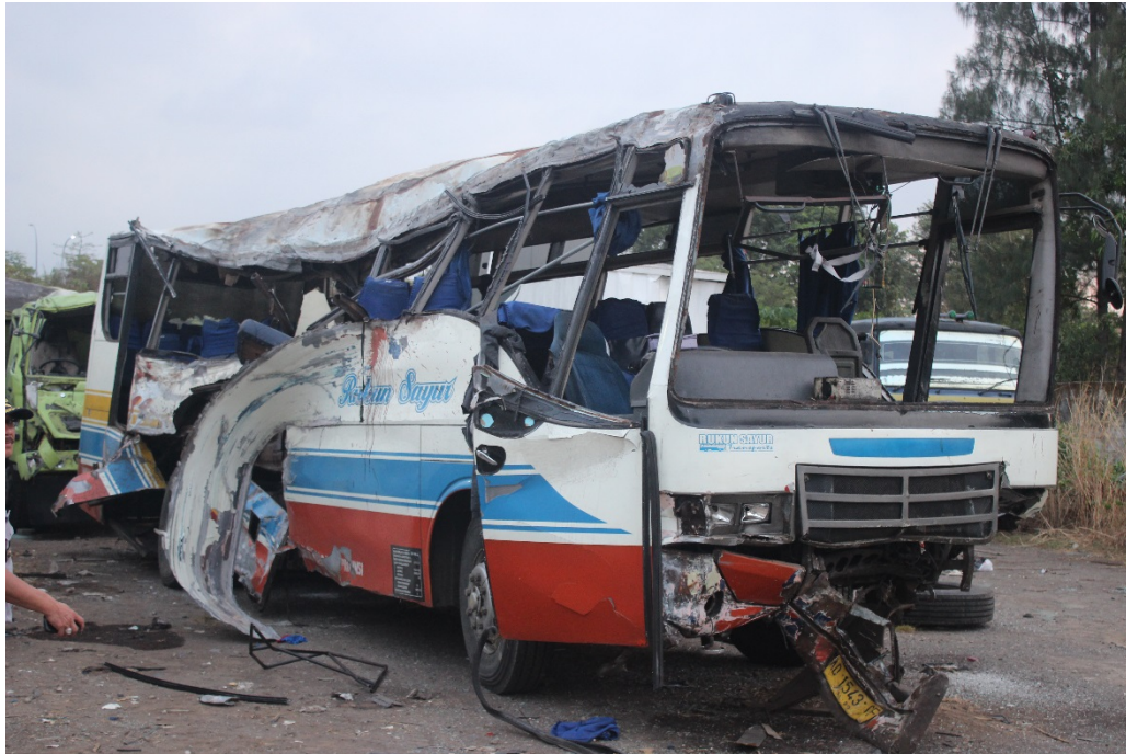
Gambar 5. Kondisi bagian sebelah kanan Mobil Bus AD-1543-CF setelah terjadinya kecelakaan.
