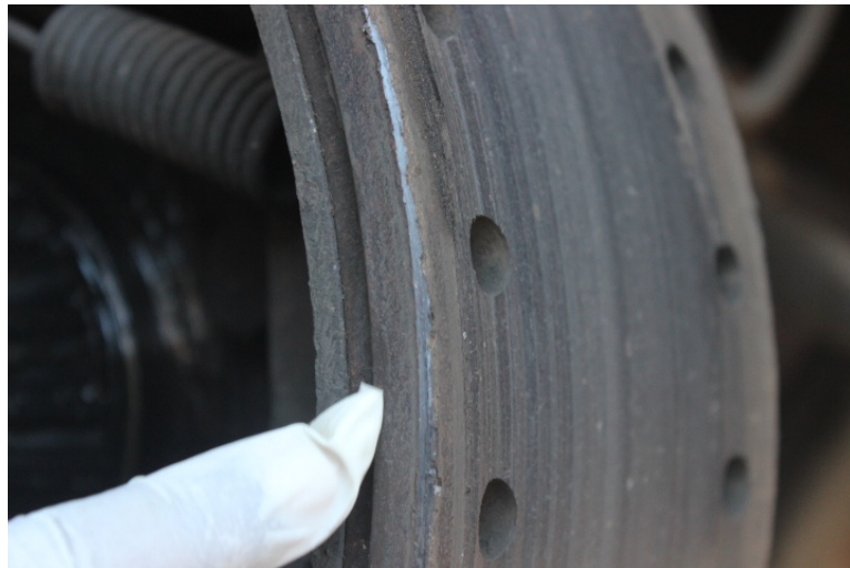
Gambar 26. Sepatu rem Mobil Bus AD-1543-CF dalam kondisi laik pakai.
