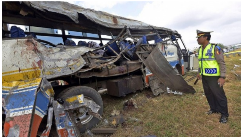
Gambar 8. Rangka dan struktur bagian kanan Mobil Bus AD-1543-CF yang terdeformasi dan patah.
