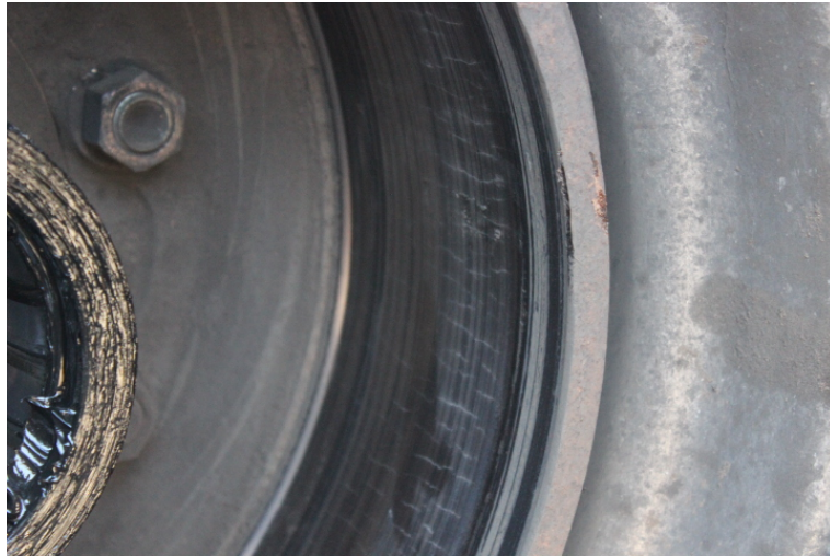
Gambar 25. Keausan pada tromol rem.
