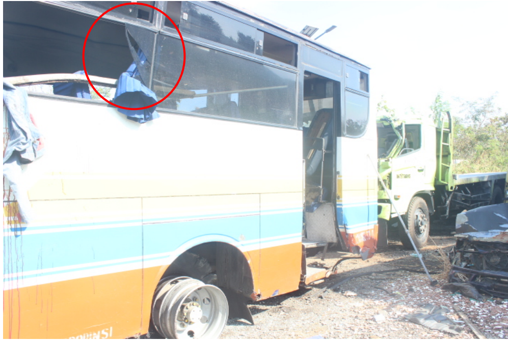
Gambar 32. Bagian kaca mobil bus yang terlihat tidak menggunakan material safety.
