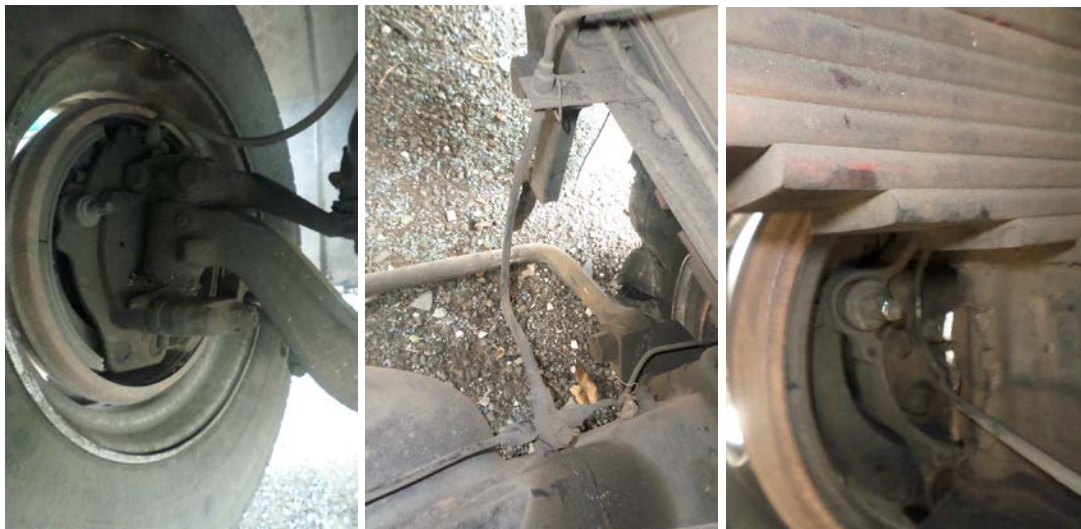
Gambar 24. Saluran fluida sistem pengereman Mobil Bus AD-1543-CF.
