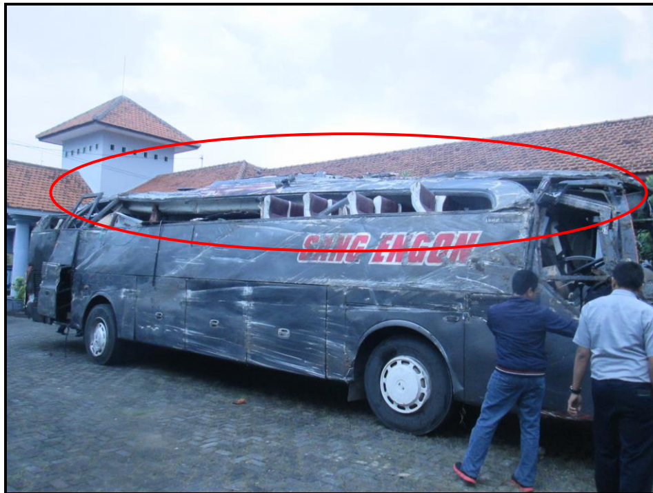
Gambar 5. Bagian kompartemen penumpang mobil bus yang mengalami rusak berat akibat benturan dengan tebing.
