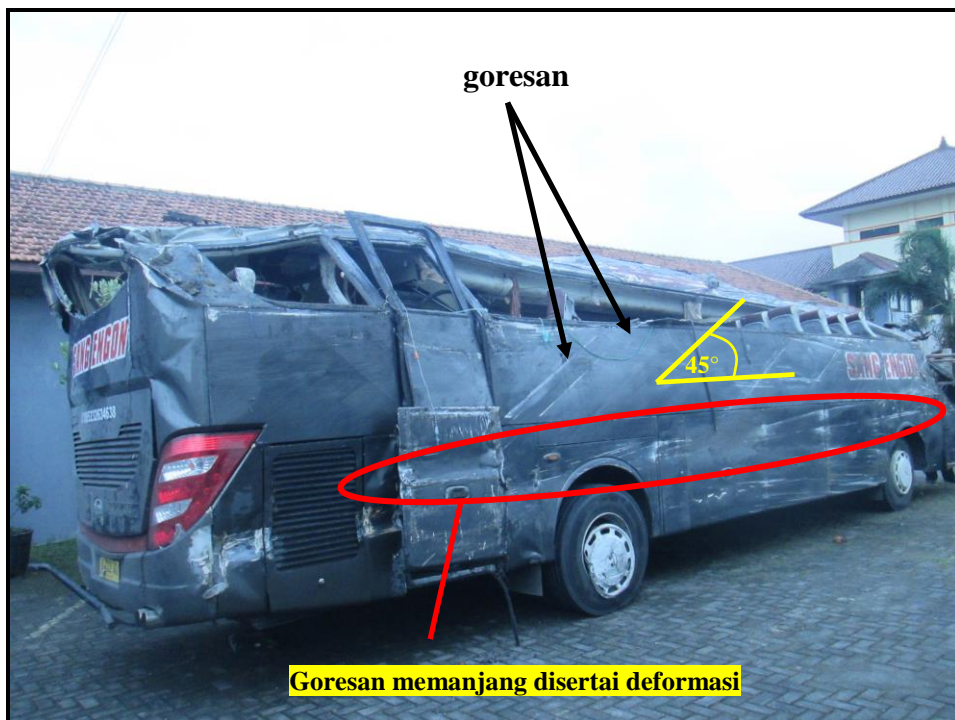
Gambar 6. Kondisi bagian sebelah kanan mobil bus setelah terjadinya kecelakaan.
