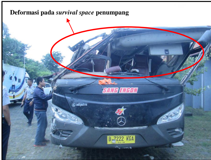
Gambar 7. Kondisi bagian depan mobil bus setelah terjadinya kecelakaan.
