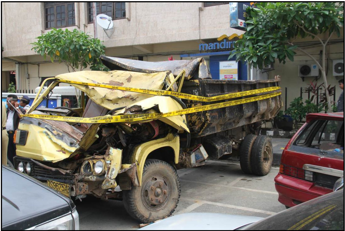
Gambar 5. Kondisi bagian sebelah kiri mobil barang dump truck DS-9675-AB setelah terjadinya kecelakaan.
