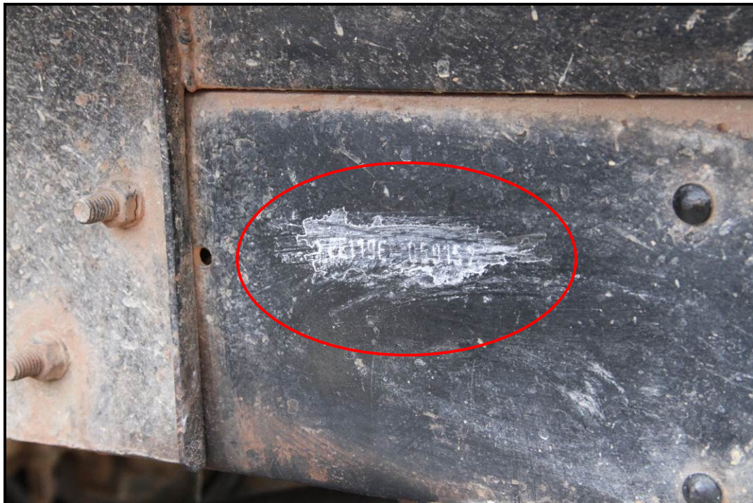
Gambar 22. Nomor rangka yang berbeda dengan nomor rangka yang tercantum dalam STNK.
