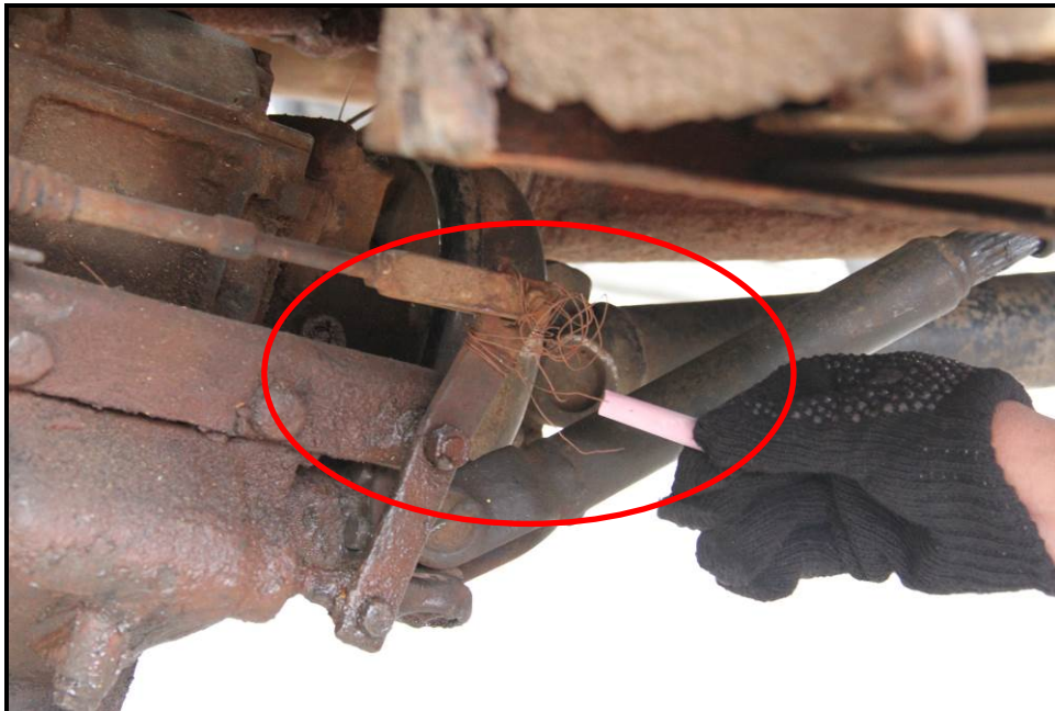
Gambar 23. Tuas penghubung PTO diikat dengan kawat.
