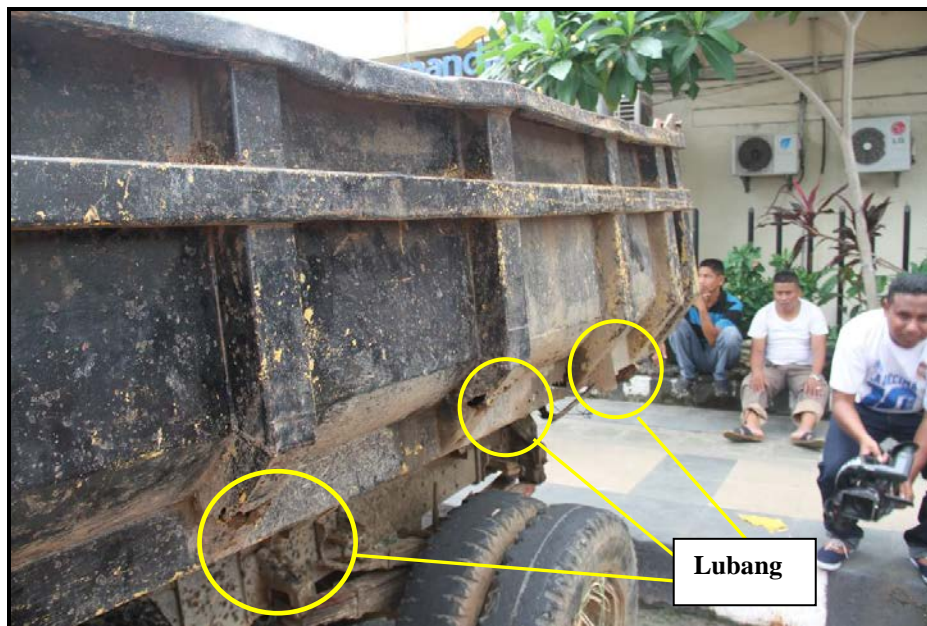
Gambar 19. Korosi pada bak kendaraan.
