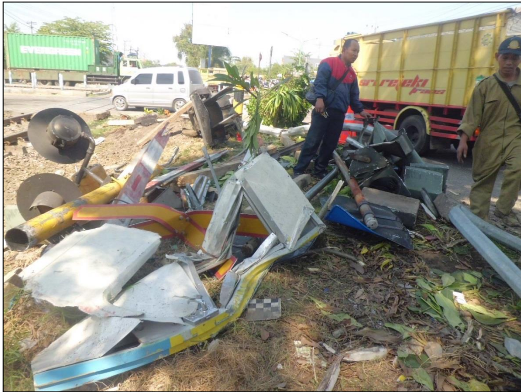
Gambar 21. Palang pintu perlintasan dan kelengkapannya serta kelengkapan jalan lainnya yang rusak akibat kecelakaan.
