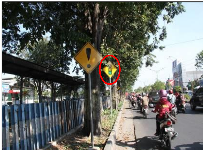
Gambar 26. Rambu peringatan agar pengguna jalan mengetahui bahwa akan terdapat pengatur lalu lintas di depan (Tabel II no. 4a1).
