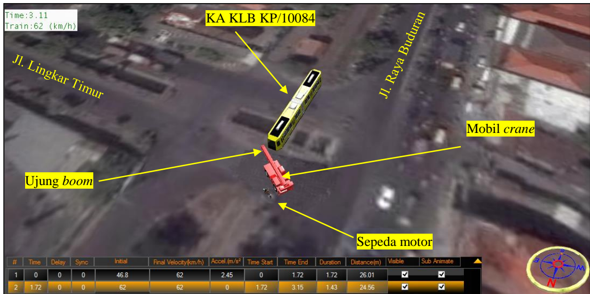
Gambar 11. Posisi mobil crane sesaat sebelum tertabrak KA KLB/10084.
