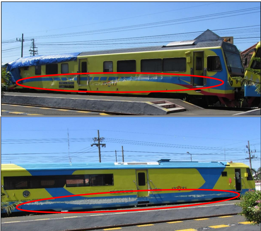
Gambar 7. Kerusakan pada sisi kiri KA KLB KP/10084. Gambar atas adalah kerusakan pada kereta ke-1 (SI31101). Gambar bawah adalah kerusakan yang terjadi pada kereta ke-2 (I092001).
