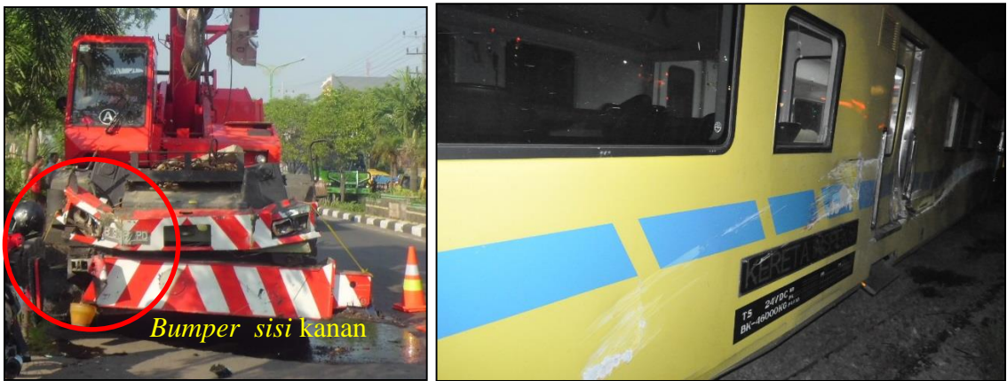
Gambar 14. Bagian sisi kiri kereta yang bergesekan dengan bumper kanan mobil crane.
