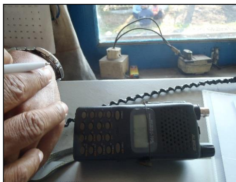
Gambar 31. HT yang harus selalu terhubung ke adaptor agar dapat berfungsi
