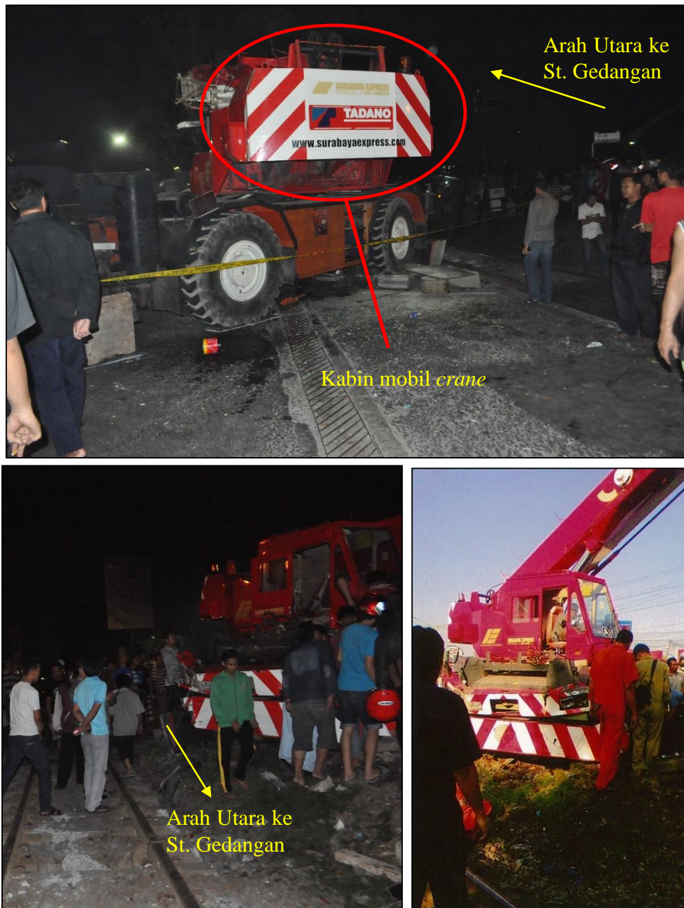
Gambar 13. Kabin mobil crane yang terayun kemudian diikuti oleh terayun dan terhempasnya landasan mobil crane ke arah utara (searah dengan perjalanan KA) setelah tertabrak KA KLB KP/10084
