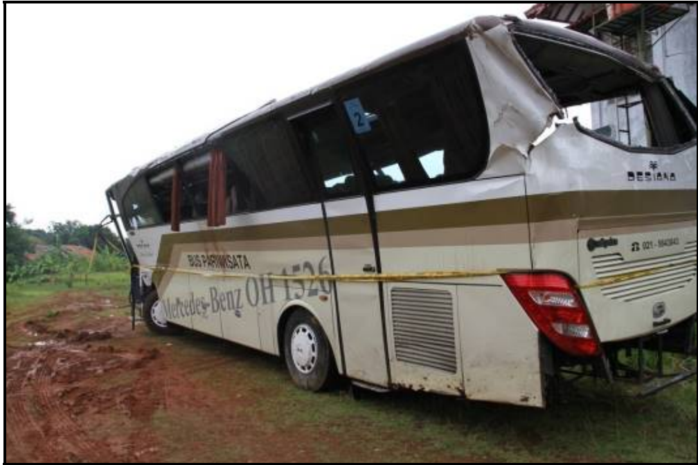
Gambar 7. Kondisi bagian sebelah kiri mobil bus B-7529-XB setelah terjadinya kecelakaan.
