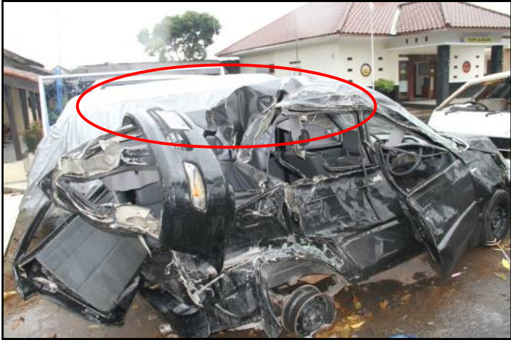
Gambar 10. Kondisi atap mobil penumpang T-1118-TK.
