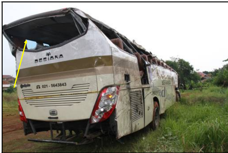
Gambar 8. Kondisi bagian belakang mobil bus B-7529-XB setelah terjadinya kecelakaan.
