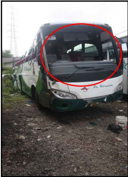
Gambar 2. Kondisi kaca mobil bus bagian depan pecah.
