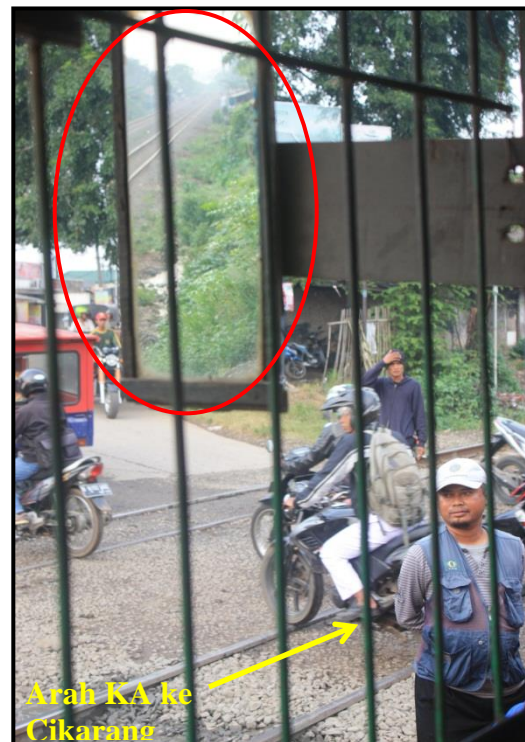
Gambar 31. Kaca yang digunakan untuk melihat kereta yang datang dari arah St. Tambun menuju ke arah Stasiun Cikarang.
