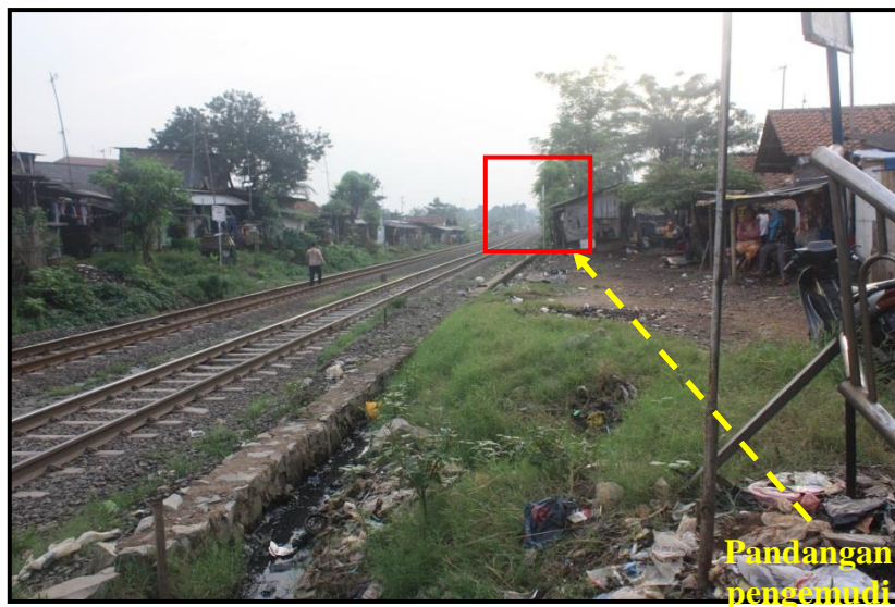
Gambar 27. Ilustrasi jarak pandang pengemudi mobil bus terhadap obyek datangnya kereta api.
