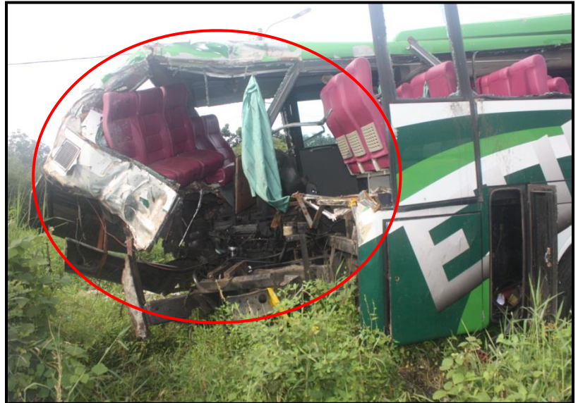
Gambar 3. Kondisi bagian belakang bodi kendaraan mengalami kerusakan parah setelah tertabrak oleh KA 108.
