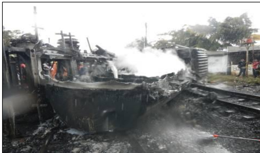
Gambar 5. Kondisi kereta tempelan tangki setelah kecelakaan
