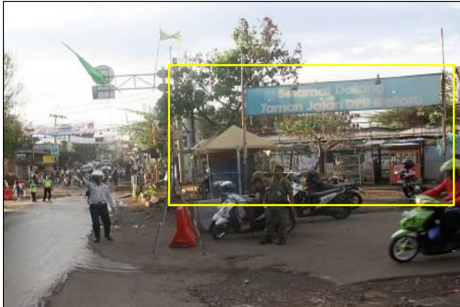
Gambar 22. Bangunan kios/warung menghalangi pandangan pengguna jalan ke arah jalur St Kebayoran
