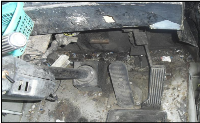
Gambar 9. Tidak ada kebocoran minyak rem atau sejenisnya di ruang kemudi
