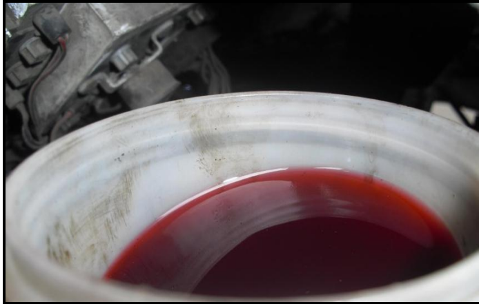
Gambar 12. Tabung minyak rem terisi penuh.
