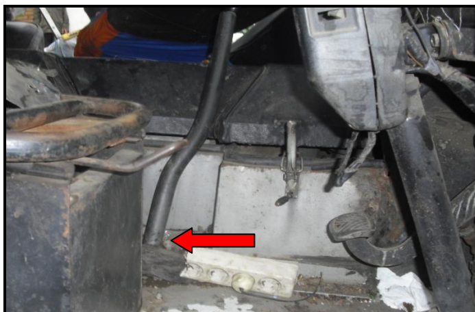
Gambar 10. Tuas persneling pada posisi gigi 3
