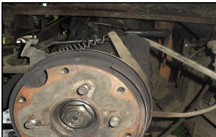
Gambar 17. Pegas dan tuas pada sistem rem parkir masih terpasang pada tempatnya
