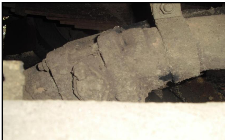
Gambar 21. Rem perlambatan terpasang baik
