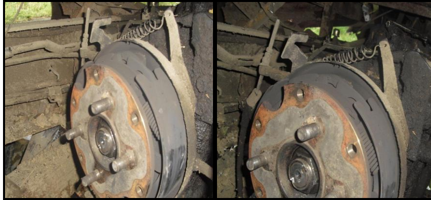
Gambar 15. Sistem rem parkir tidak terdapat kerusakan
