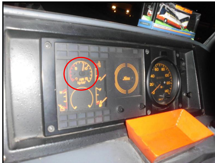
Gambar 3. Indikator tekanan rem angin masih menunjukkan kondisi angin penuh yaitu 8.1 bar
