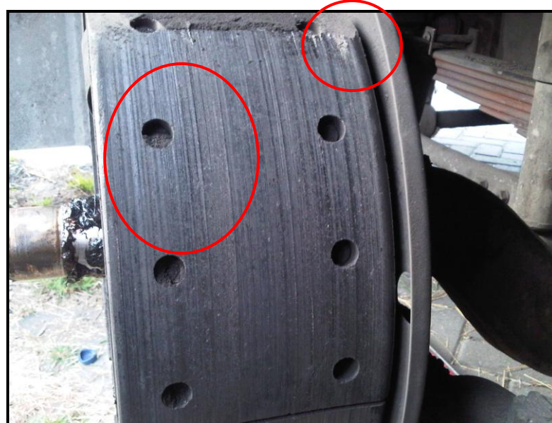
Gambar 13. Tromol dan Kanvas rem roda depan sebelah kiri beralur
