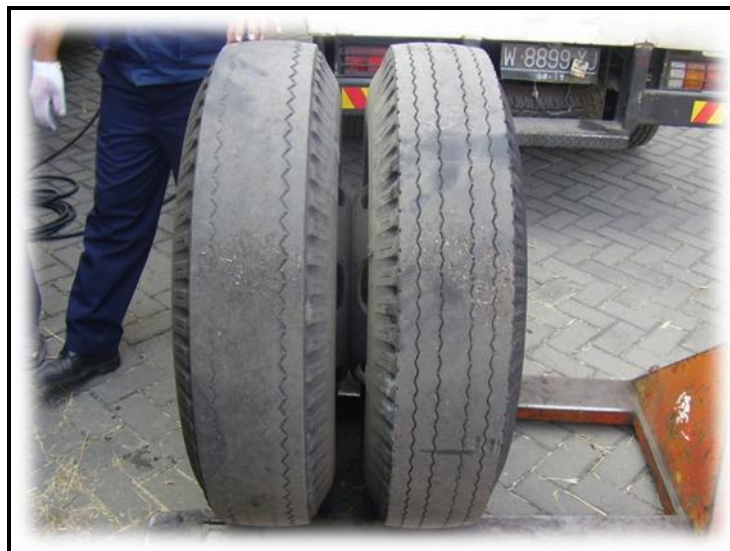
Gambar 7. Kondisi ban belakang roda kanan bagian dalam mobil bus tidak beralur atau 0 milimeter
