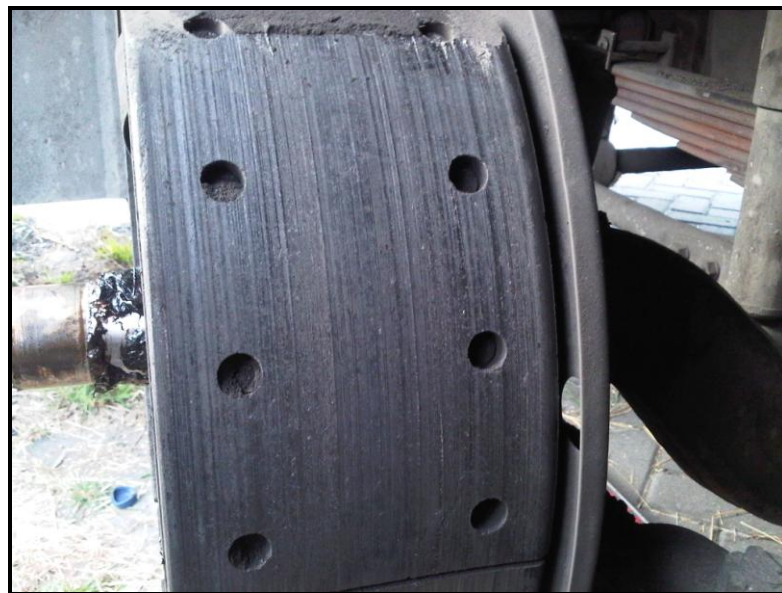
Gambar 5. Tromol dan Kanvas rem roda depan sebelah kiri beralur
