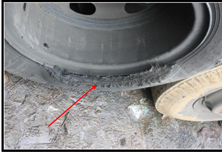
Gambar 4. Kondisi robek pada ban belakang kanan sisi dalam
