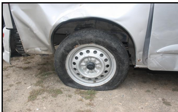
Gambar 12. Ban bagian belakang sebelah kanan dalam kondisi kempes
