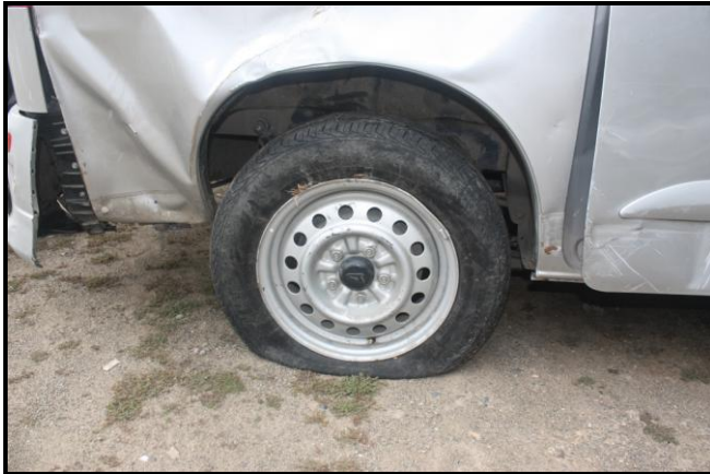
Gambar 10. Kondisi ban belakang bagian sebelah kanan mobil penumpang BK 1394 KO
