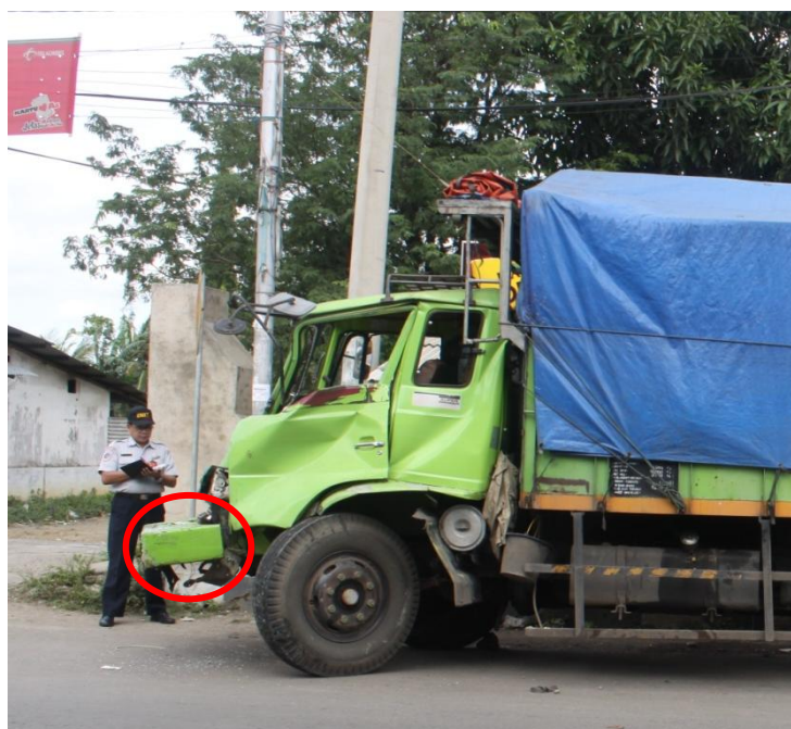
Gambar 5. Bumper yang tidak standar pada truk gandeng AG 8075 UA
