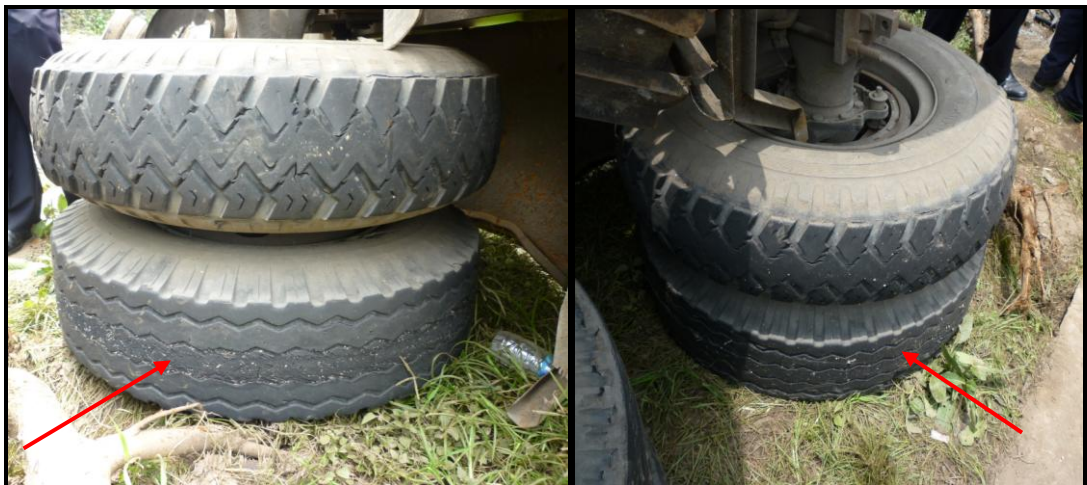
Gambar 4. Kondisi ban kereta tempel L 9806 UD tidak dalam kapasitas dan kembang ban yang seragam
