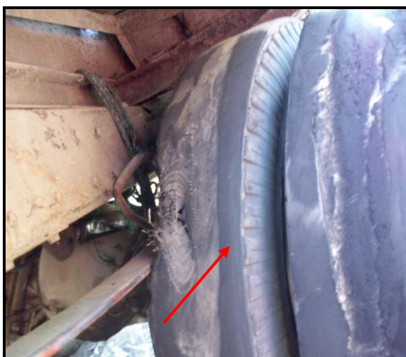
Gambar 12. Ban sebelah kanan bagian belakang mobil bus keduanya gundul dan tidak memenuhi syarat
