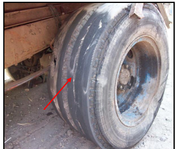
Gambar 12. Ban sebelah kanan bagian belakang mobil bus keduanya gundul dan tidak memenuhi syarat
