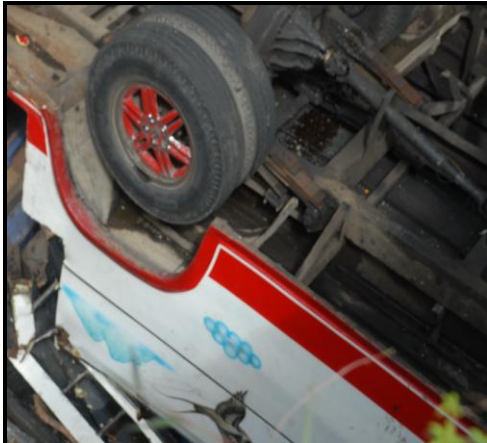
Gambar 3. Mobil bus BA 3824 E menggunakan velg roda tidak standard
