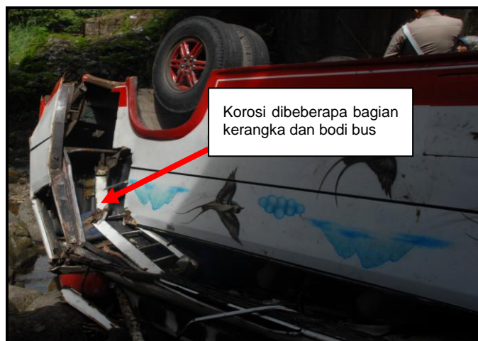
Gambar 5. Korosi/karat di beberapa bagian kerangka
