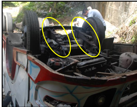
Gambar 6. Jumlah bilah per daun pada suspensi dan bodi bus bagian depan kendaraan yang berbeda
