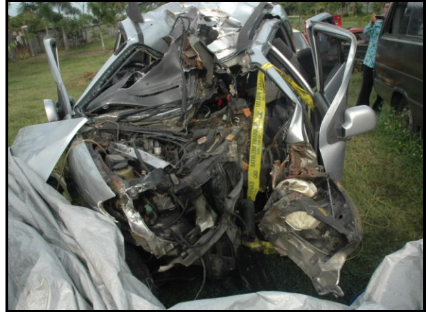
Gambar 11. Kerusakan pada bagian depan kendaraan
