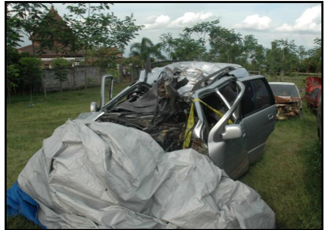
Gambar 12. Kerusakan pada bagian atap kendaraan
