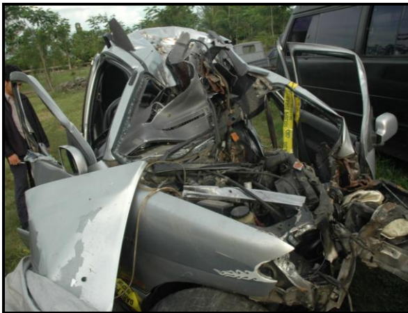
Gambar 12. Kerusakan pada bagian atap kendaraan
