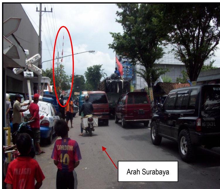
Gambar 6. Palang pintu perlintasan tertutup kendaraan yang parkir di depan gedung
