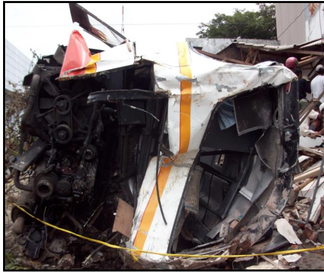
Gambar 8. Kondisi bagian belakang mobil bus AG 7493 UR
