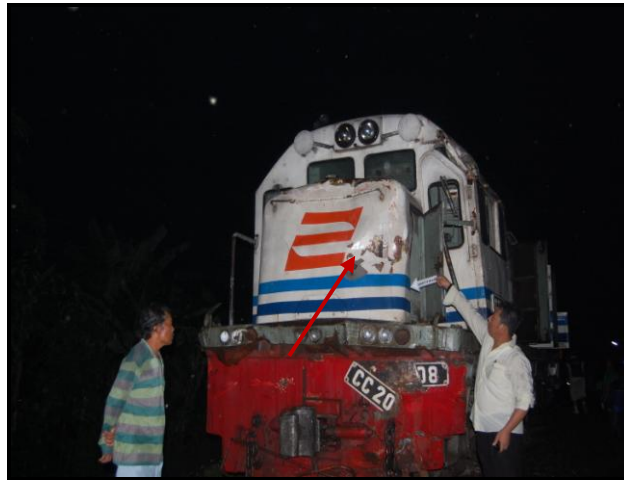
Gambar 13. Bagian depan lokomotif penyok akibat tabrakan
