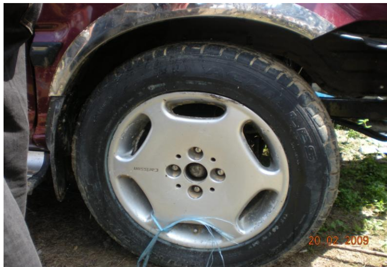
Gambar 4. Velg dan ban kendaraan diubah ke ukuran yang lebih besar
