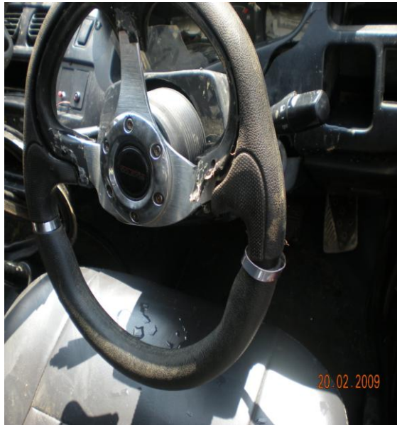
Gambar 3. Kemudi yang sudah diganti diameter 32 cm
