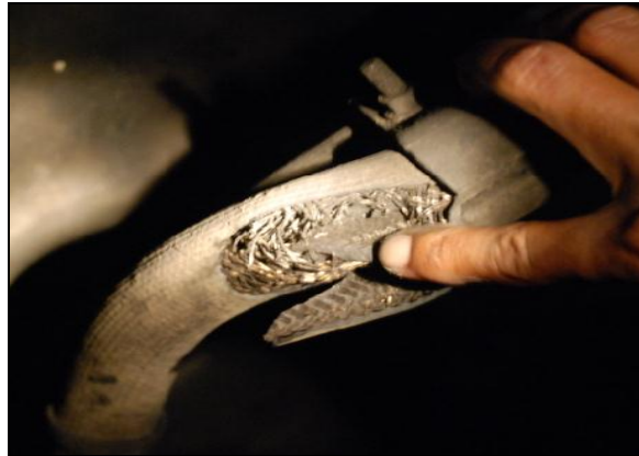
Gambar 6. Selang angin sistem rem yang bocor
