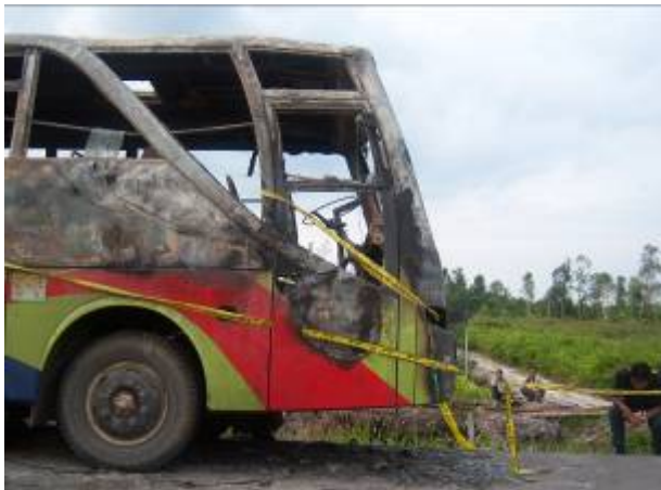
Gambar 25 kondisi ban depan yang tidak terbakar
