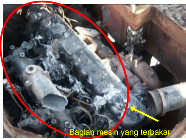
Gambar 17 kondisi mesin yang terbakar
