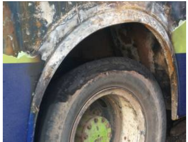
Gambar 26 kondisi ban belakang kiri yang terbakar
