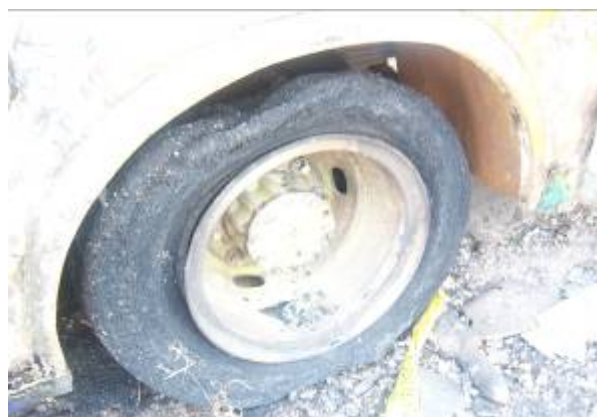
Gambar 27 kondisi ban belakang kanan yang terbakar
