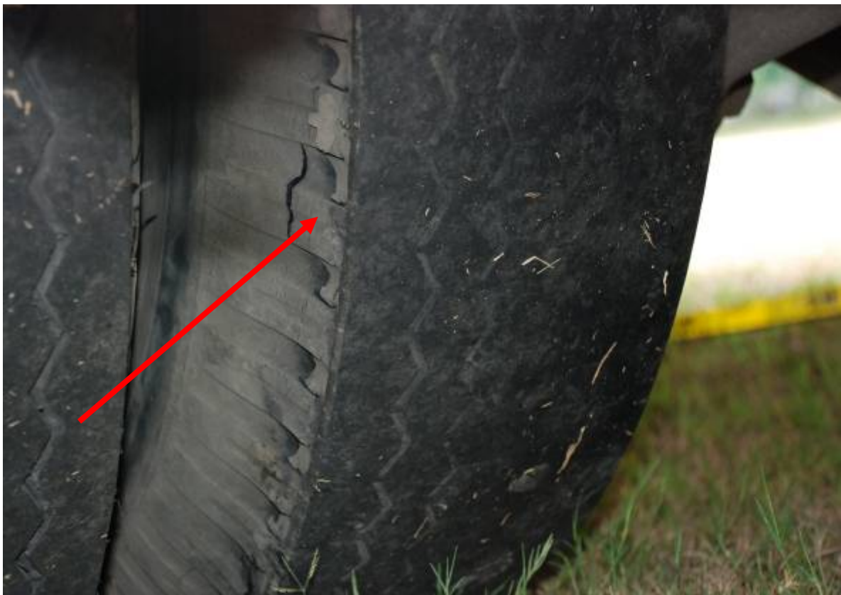
Gambar Sarana 1 : Ban belakang menggunakan ban vulkanisir dan telah aus
