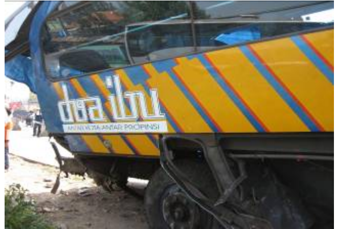
Gambar 8. Bagian kiri depan bus hancur akibat menabrak pagar tembok showroom
