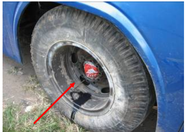
Gambar 14. As roda kiri belakang tidak ada pada tempatnya
