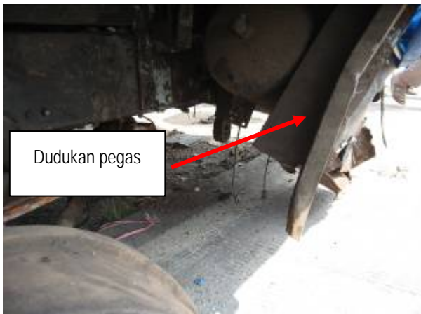
Gambar 7. Dudukan pegas daun bagian kanan depan terlepas dan bagian depan kanan bus hancur akibat tabrakan
