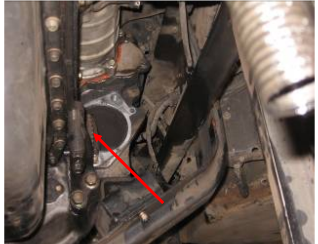
Gambar 12. Starter tidak ada pada tempatnya
