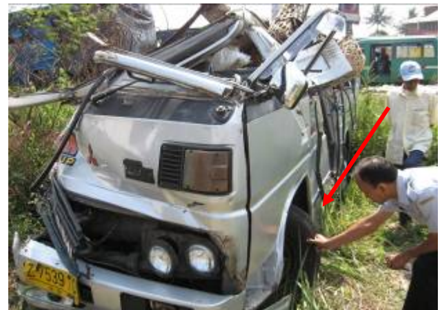
Gambar 10. Ban kiri mengarah ke kanan
