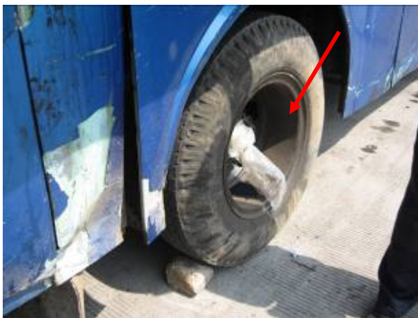
Gambar 13. As roda kanan belakang tidak ada pada tempatnya
